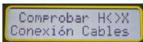
Ilustración 66: Alarma de Falla en la Continuidad de Cables.
