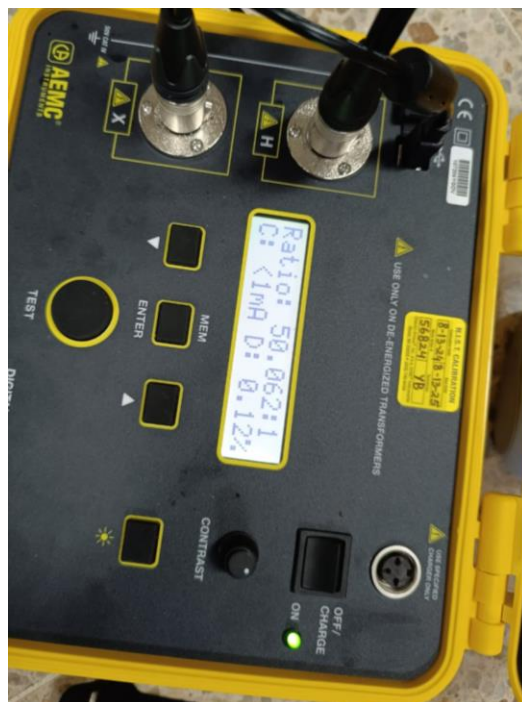
Ilustración 107: Equipo TTR/DTR AEMC 8510 Entregando los Resultados de una Prueba.
