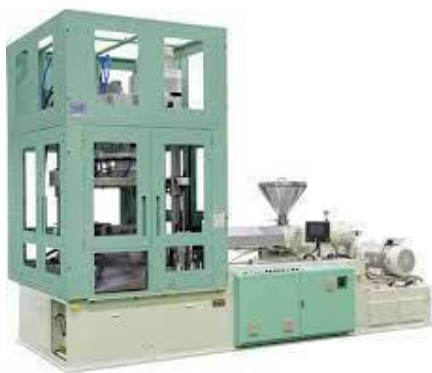
Ilustración 2 - Máquina para soplado PET AOKI SBIII-500-150
