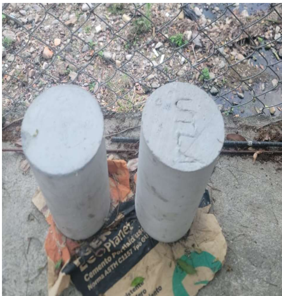
Imagen 60: Comportamiento del concreto a los 28 días de elaborado los cilindros.
