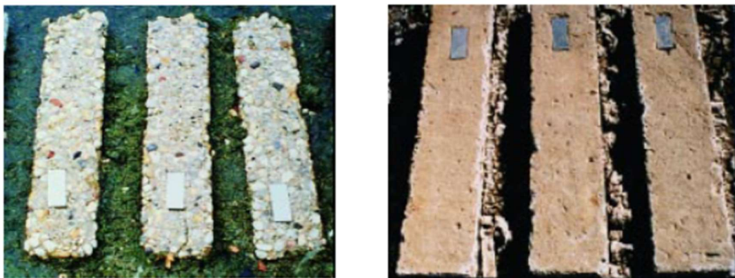
Imagen 9: las muestras de pruebas usadas en el ensayo de sulfatos en ambiente externo.
