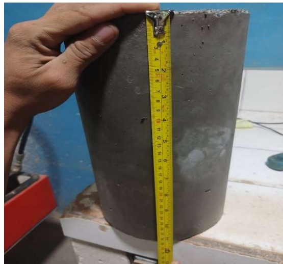
Imagen 49: Medidas del cilindro tomadas en laboratorio.
