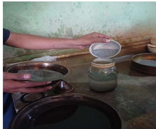
Imagen 37: Preparación de muestra saturada.
