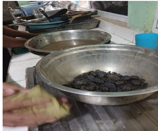
Imagen 28: Pesaje de agregados grueso para cálculo de porcentaje de humedad.
