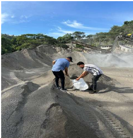
Imagen 15: Toma de muestra de arena de canteras.
