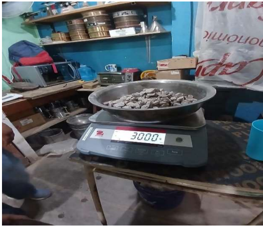
Imagen 28: Pesaje de agregados grueso para cálculo de porcentaje de humedad.
