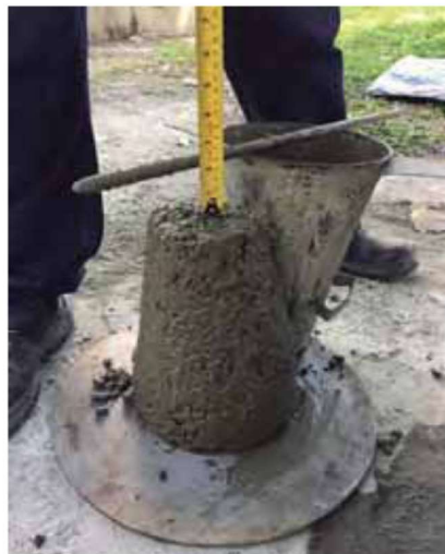
Imagen 10: Ensayo de Asentamiento o del Cono de Abrams.
