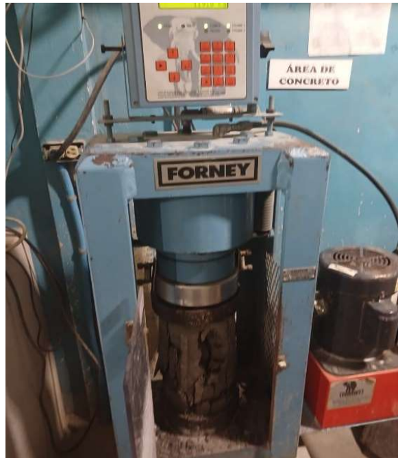
Imagen 51: Colocación de cilindro sometido a compresión en laboratorio.
