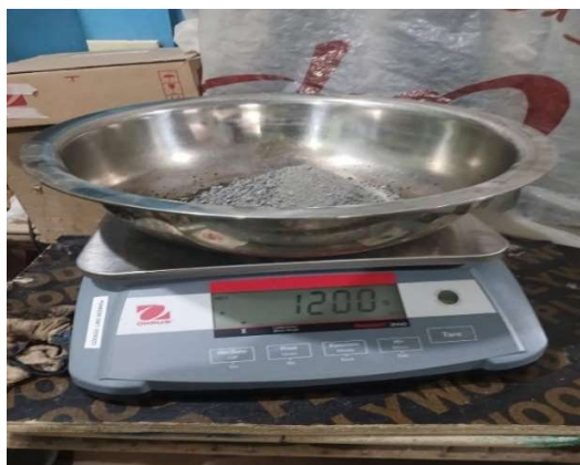
Imagen 27: Pesaje de agregado fino para cálculo de porcentaje de humedad.
