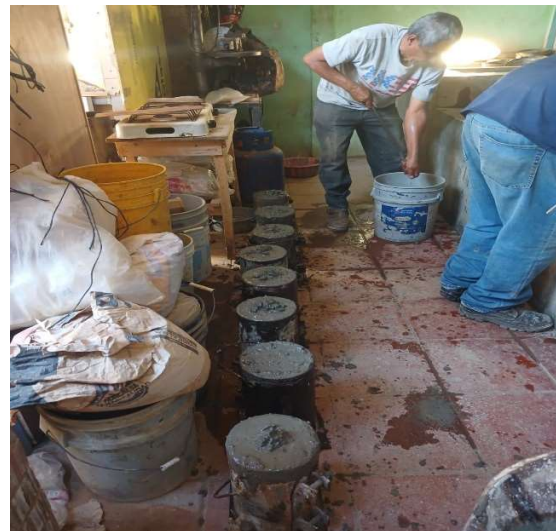
Imagen 47: Cilindros listos para ser curados.
