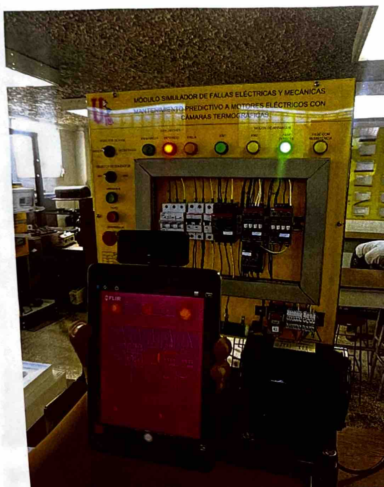
Imagen 6. 7- Módulo simulador de fallas en funcionamiento. Fuente: Imagen propia.
