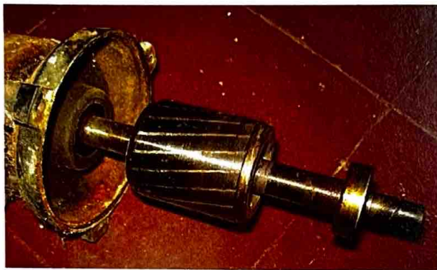
Imagen 2. 45– Rotor Jaula de ardilla de una bomba centrífuga de agua. Fuente: Imágenes Google, julio 2020.
