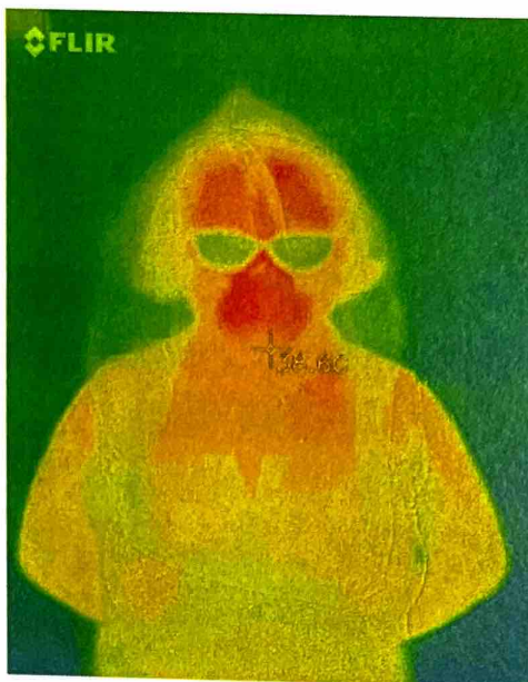
Imagen 3. 16– Radiación infrarroja atraviesa plástico fino. Fuente: Imagen propia.
