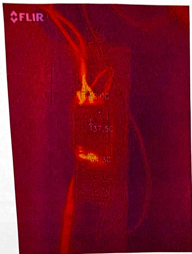
Imagen 4. 7– Puntos calientes en contactor monofásico 240 v. Fuente: Propia
