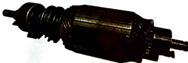
Imagen 2. 36– Rotor de colector. Fuente: Imágenes Google, septiembre 2018.
