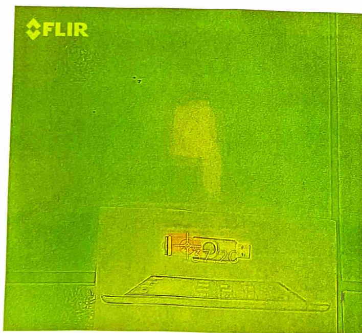
Imagen 3. 22– Pendrive conectado al ordenador durante varios minutos. Fuente: Imagen propia.
