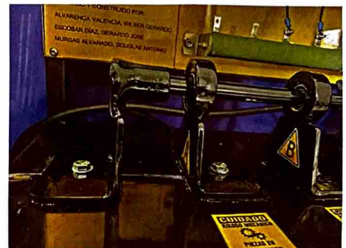
Imagen 6.39 - Acoplamiento correcto de accesorio de bloqueo de rotor. Fuente: Imagen propia.
