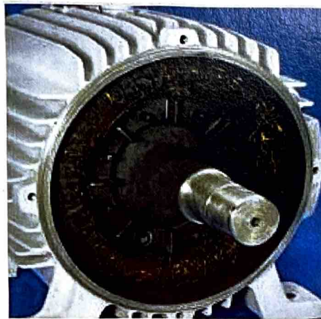
Imagen 6. 8-Bobinado con daño a causa de rotor bloqueado. Fuente: WEG Daños en los bobinados.
