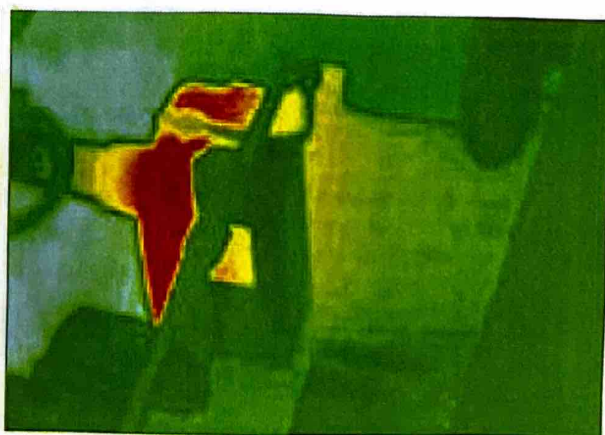
Imagen 3. 37– Motor eléctrico con problema de rodamiento. Fuente: FLIR. Guía de termografía para mantenimiento predictivo.
