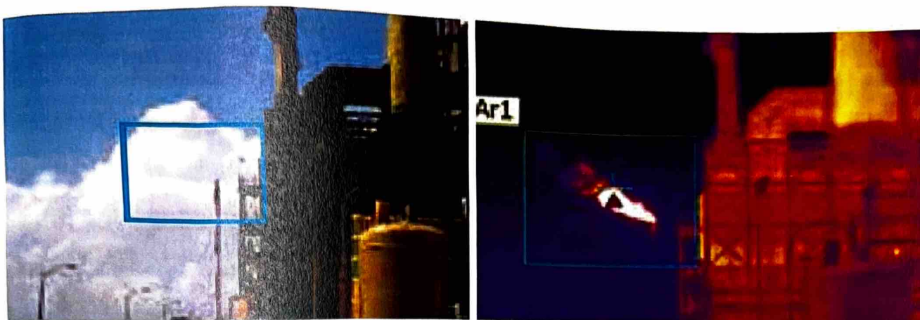
Imagen 3. 41– Llama invisible a simple vista. Fuente: FLIR. Guía de termografía para mantenimiento predictivo.
