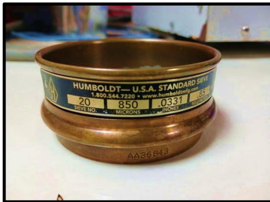
Fotografía 3. Tamiz #20 para verificar el tamaño de partículas.
