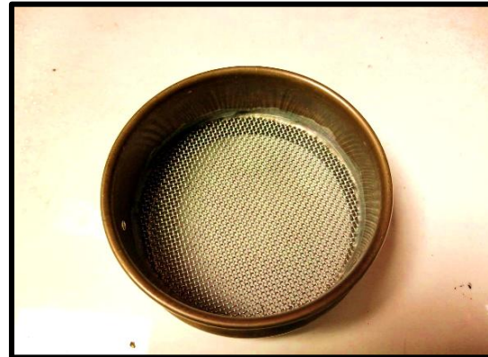
Fotografía 3. Tamiz #20 para verificar el tamaño de partículas.
