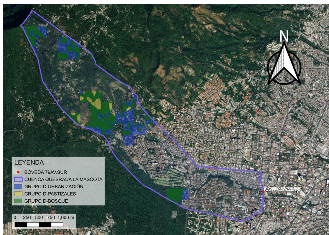
Figura 3.13 Cuenca de estudio con la sobreposición del Grupo Hidrológico D y tipos de superficie. Fuente: Elaboración propia.
