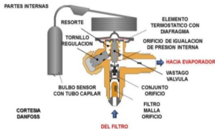
Figura 9: Válvula de expansión
