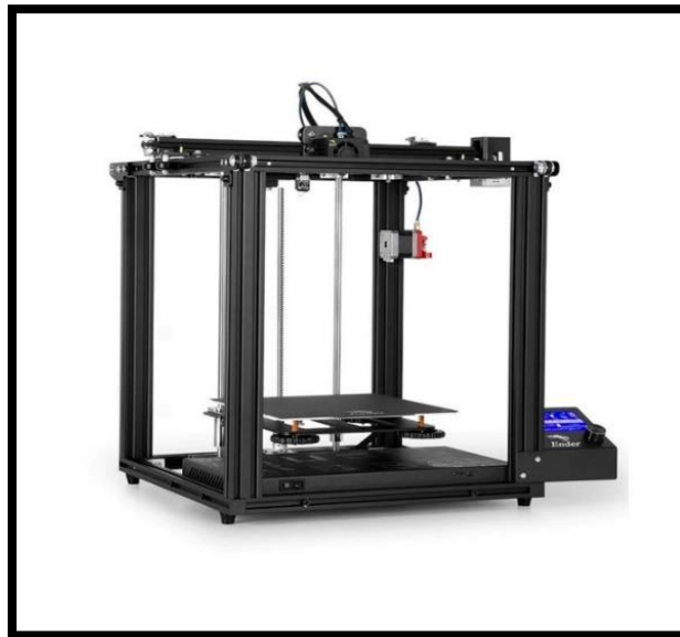
Ilustración 19. Impresora 3D Ender 5.
