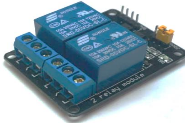
Figura 67: Módulo de relé de 2 canales HL-52S
