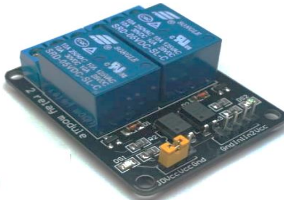
Figura 68: Módulo de relé de 2 canales HL-52S – alimentación y señales de control
