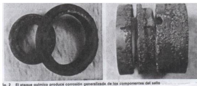
fig. 2 El ataque químico produce corrosión generalizada de los componentes del sello
