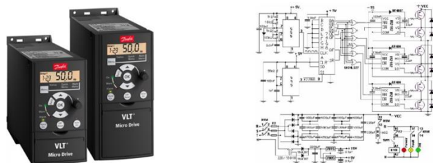
Para mejorar la eficiencia respecto al punto anterior, normalmente se procede a la colocación de variadores de frecuencia en el sistema de bombeo. Un variador de frecuencia es un dispositivo electrónico que modifica la velocidad del motor asíncrono que mueve los álabes de la bomba con la finalidad de adecuar la velocidad a la necesidad mayor o menor de caudal. Cabe la posibilidad de variar la frecuencia manualmente para ajustar el punto de operación deseado, o bien, implementando un autómatas que, mediante realimentación en lazo cerrado, varíe la velocidad en función de los requerimientos. La primera posibilidad es eficaz en instalaciones con un caudal fijo, la segunda sería la óptima en instalaciones con caudal variable.
