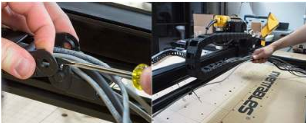
Figura 62. Respectivo cableado de los drivers.
