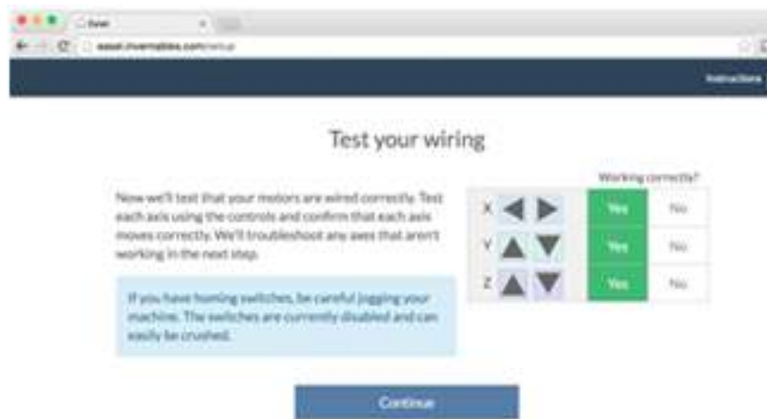
Figura 65. Control manual en ejes de EASE.
