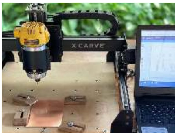
Figura 37. Vista del área de trabajo, cartesiana del CNC X-Carve
