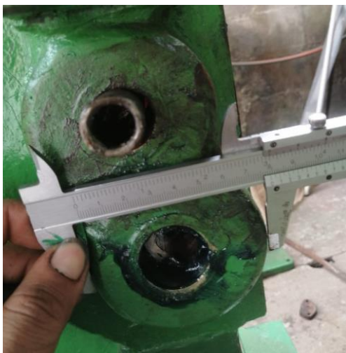
Bujes de bronce, deben limpiarse y lubricarse.
