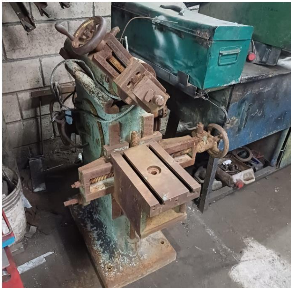
Ilustración 23: Cepillo mecánico antes de restauración.
