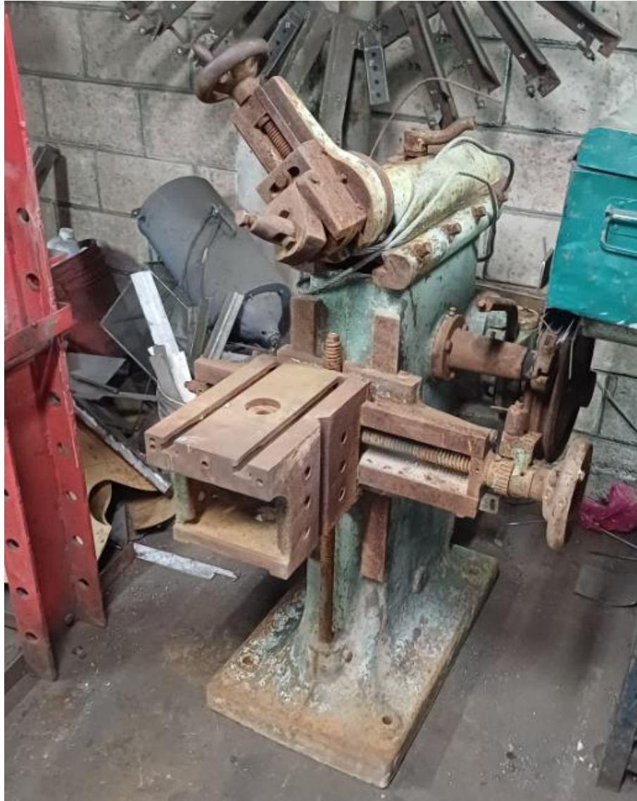
Ilustración 24: Cepillo mecánico antes de restauración.
