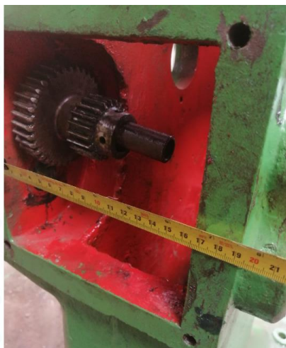
Proceso de desmontaje y extracción de eje de piñones
