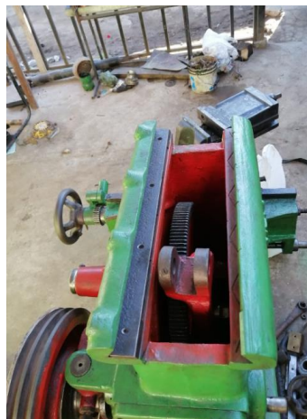
Guías tipo milano del chasis y cuña.
