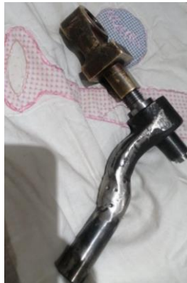
Pivote de bronce de Biela, esparrago con doble rosca y palanca de apriete.
