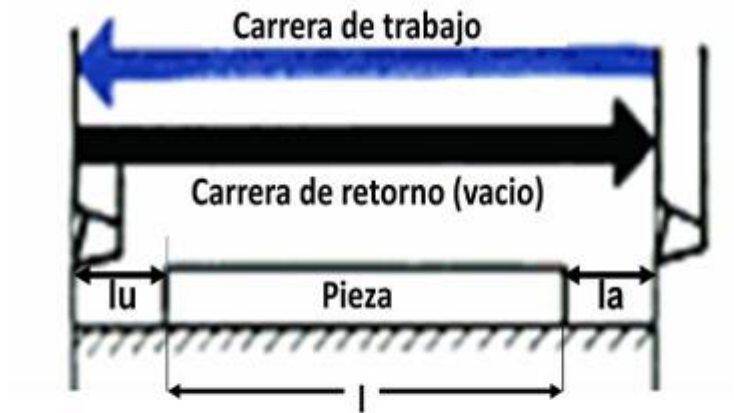
Fig. 1.10 Longitud de la carrera de la herramienta
