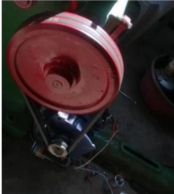
Polea conductora y conducida por fajas
