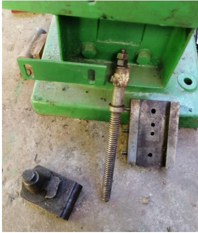
Placa portaherramientas, tornillo de avance, placa de guía de milano.
