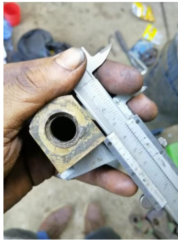
Tuerca de bronce de tornillo de avance de corte.
