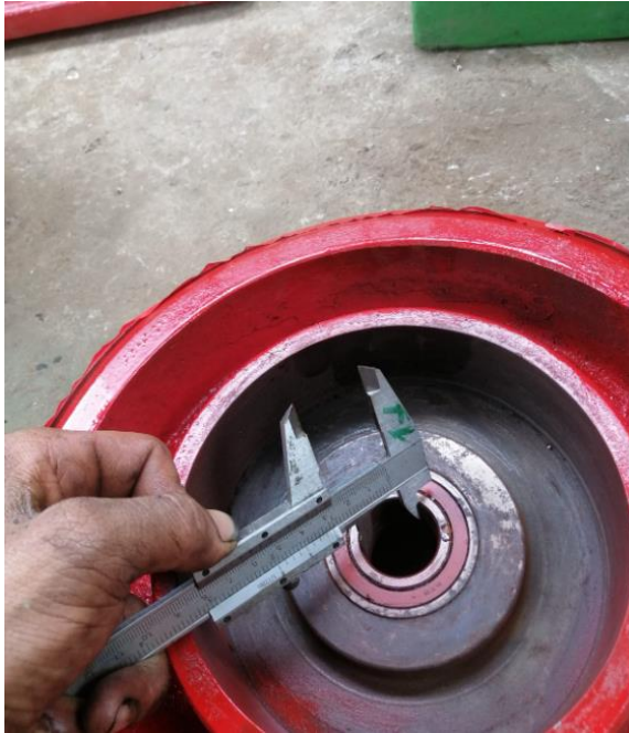
Rodamiento y alojamiento cónico de polea de clutch.
