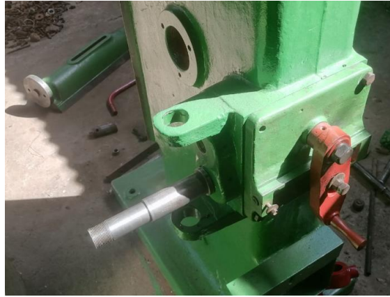
Eje de transmisión con el sistema de clutch desmontado
