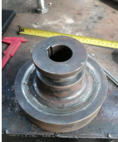
Polea cónica de mecanismo de clutch
