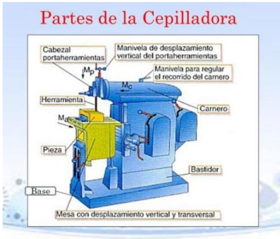
Ilustración 7: Partes de la cepilladora.
