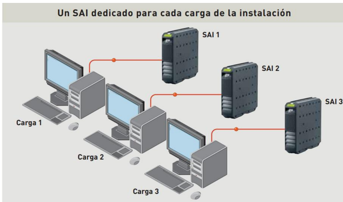
Figura 38. Arquitectura distribuida entre UPS y cargas. 56
