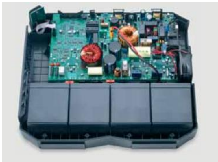
Figura 56. Parte interna de las baterías de los UPS. 78
