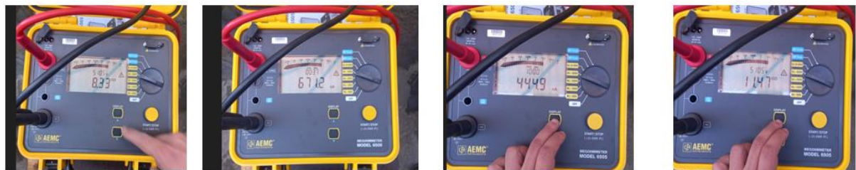
Figura 70. Evidencia de resultados obtenidos de las pruebas eléctricas en configuración PH2/Tierra obtenidos en un periodo de tiempo de 10 minutos registrables. 117
