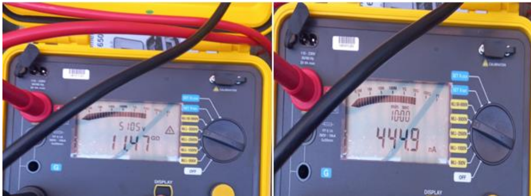
Figura 69. Resultado de los valores medidos con el megóhmetro con la resultante del índice de polaridad. 116
