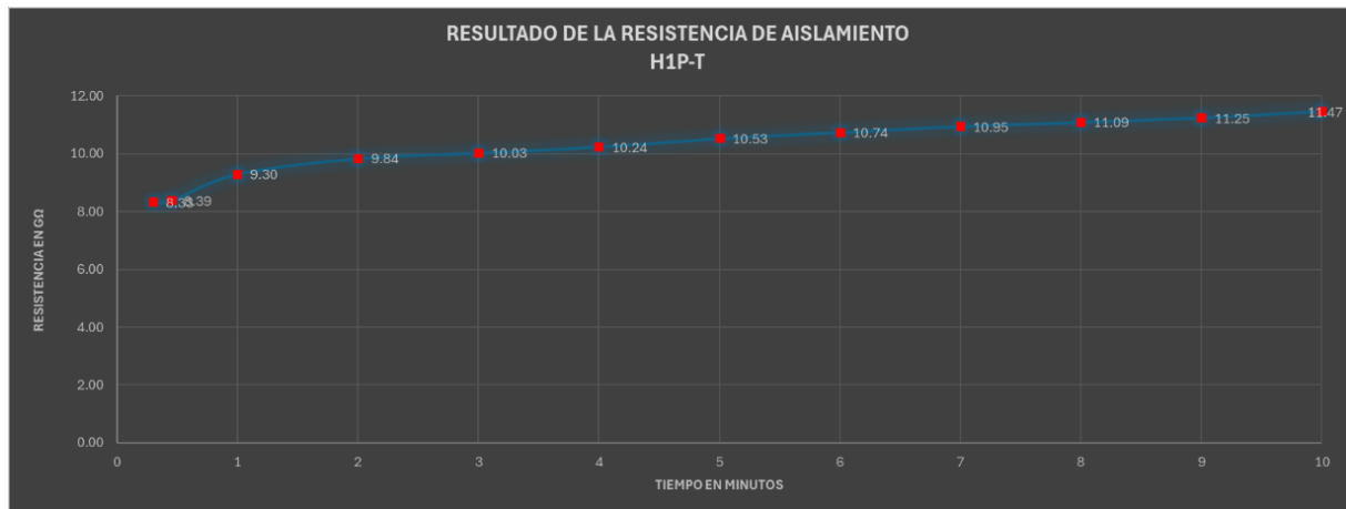
Grafica 1. Indicadores del rendimiento de la resistencia aislamiento en H1P-T.
