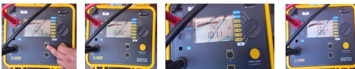
Figura 72. Evidencia de resultados obtenidos de las pruebas eléctricas en configuración SX1/Tierra obtenidos en un periodo de tiempo de 10 minutos registrables. 119
