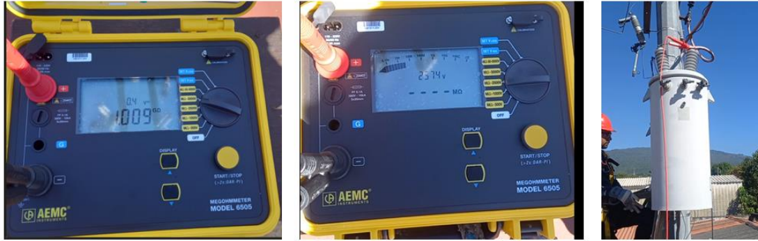
Figura 60. Programación manual del periodo de inyección de voltaje en 1 minuto /5000VDC, configuración PH2+/T. 108
