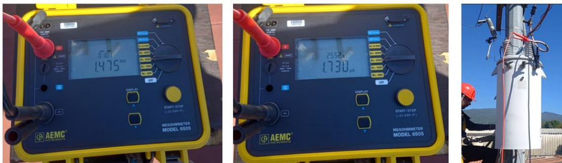
Figura 61. Programación manual del periodo de inyección de voltaje en 1 minuto /2500VDC, configuración PH2/SX3. 109
