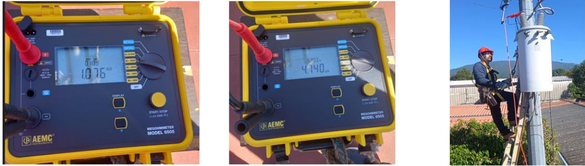
Figura 57. Programación manual del periodo de inyección de voltaje en 1 minuto /5000VDC, configuración PH1+/T-. 105
