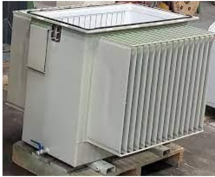
Figura 12. Tanque de un transformador eléctrico 12
