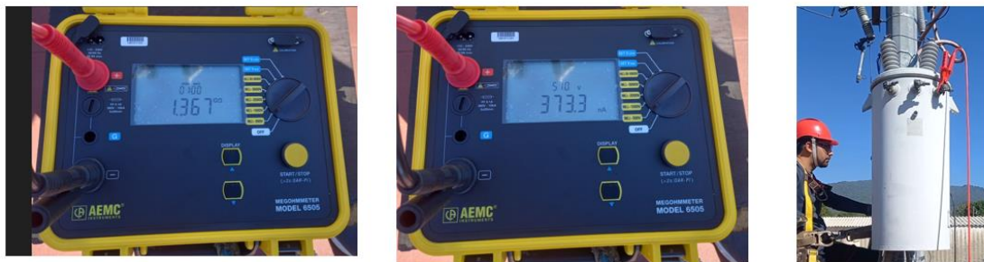
Figura 61. Programación manual del periodo de inyección de voltaje en 1 minuto /2500VDC, configuración PH2/SX3. 109
