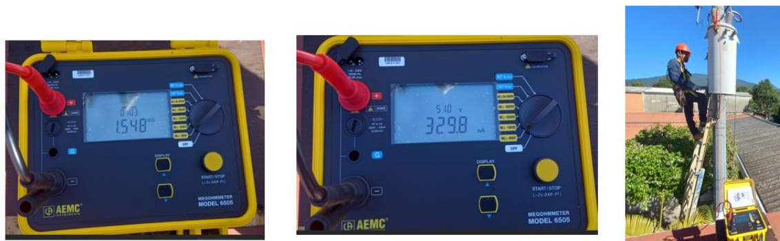
Figura 58. Programación manual del periodo de inyección de voltaje en 1 minuto /500VDC, configuración SX1+/T-. 106
