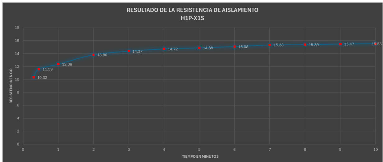
Grafica 2. Indicadores del rendimiento de la resistencia de aislamiento en H1P-XS1.
