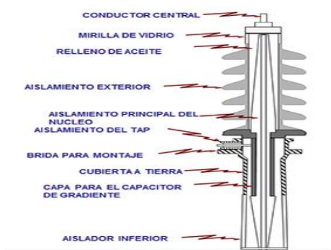
Figura 16. Partes de una boquilla bushing. 16
