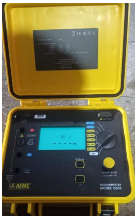
Figura 74. Instrumento en físico validación de funcionamiento Megóhmetro
