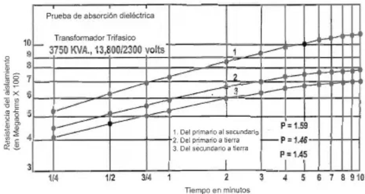
Gráfica 5. Pruebas de absorción dieléctrica de donde se puede calcular el índice de polarización (IP) (cortesía de Factory Mutual).
