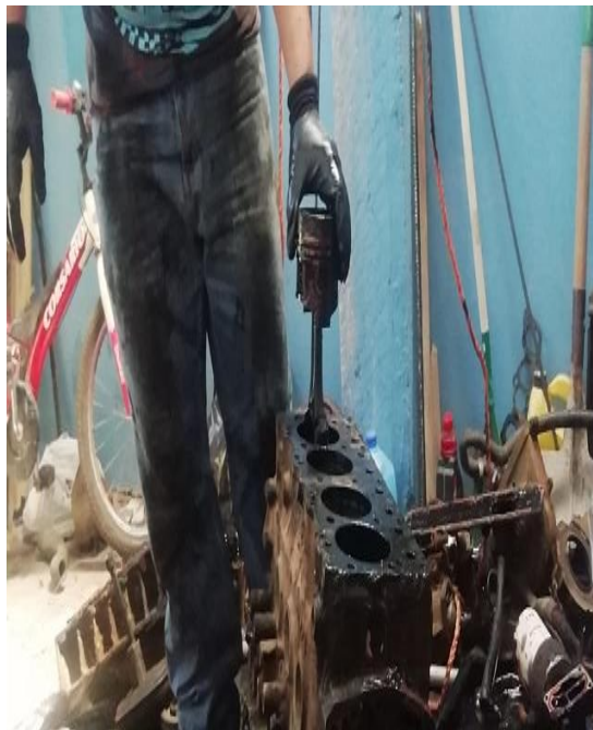
Desmontaje de pistones.
