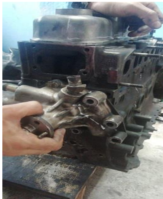
Seccionamiento de bomba de agua.
