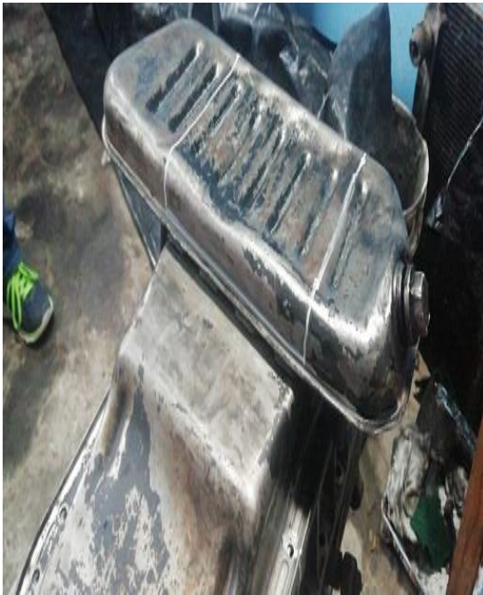
Seccionamiento de cárter.
