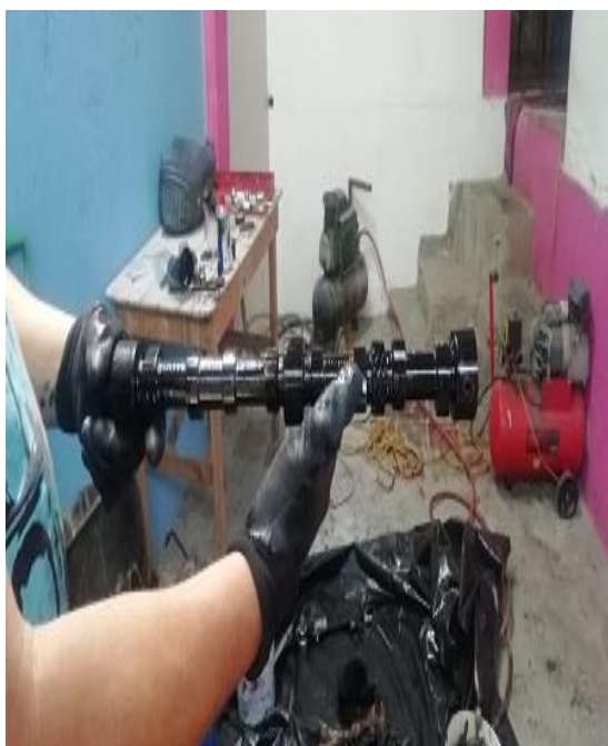
Desmontaje de eje de levas.
