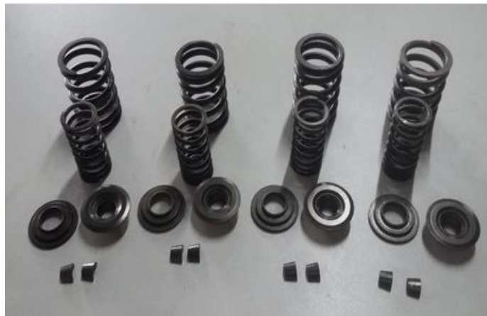
Figura 6: Resortes, cuñeros y platos de válvulas.
