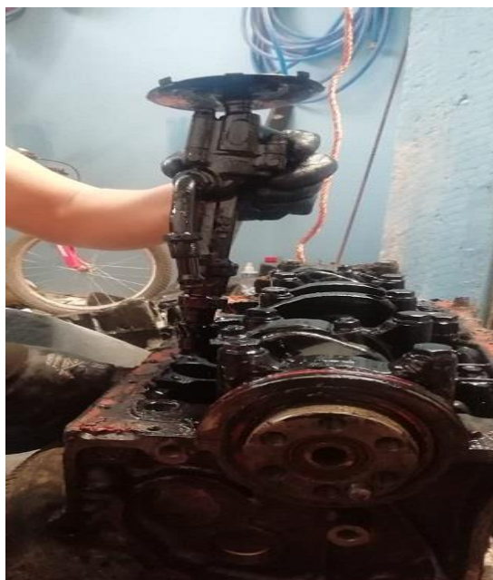
Desmontaje de cárter y bomba de aceite.
