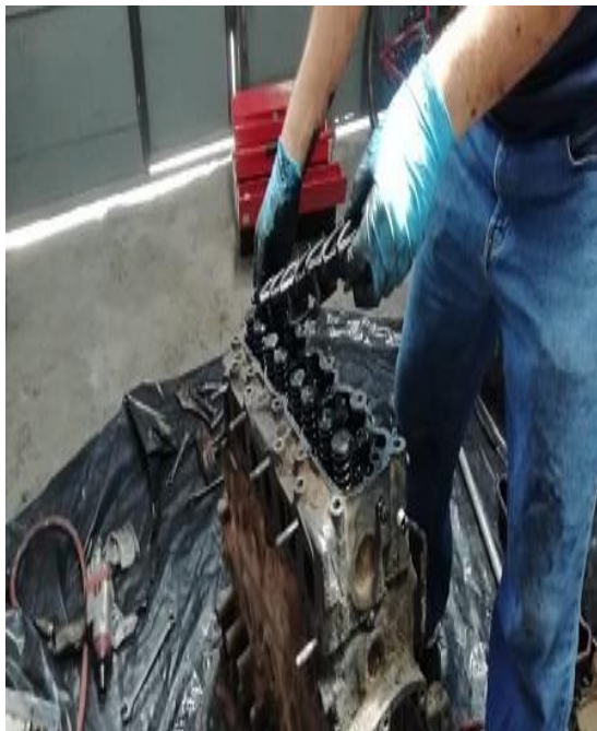
Desmontaje de balancines.
