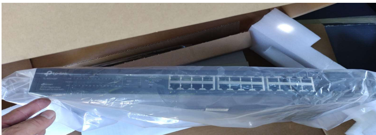
Fotografía 17 Switch de 24 puertos marca Tplink.
