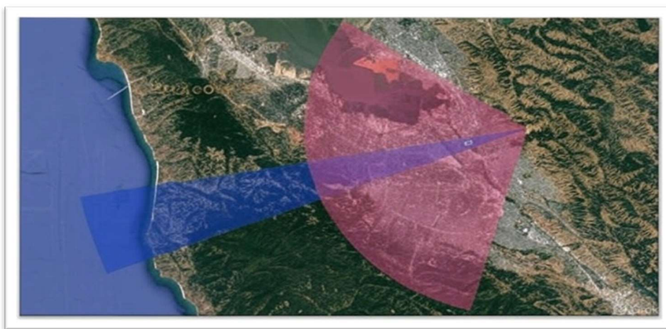
Imagen 37 Cobertura de la antena sectorial de 90 grados
