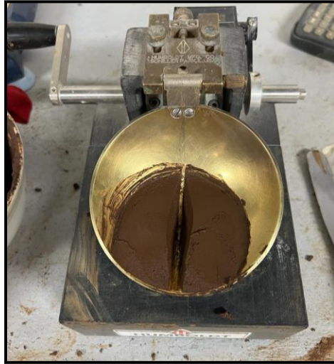
Ilustración 28. Copa de casa grande para determinación de límite líquido.
