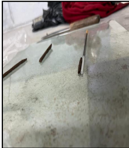
Ilustración 29. Cilindros para determinar el límite plástico
