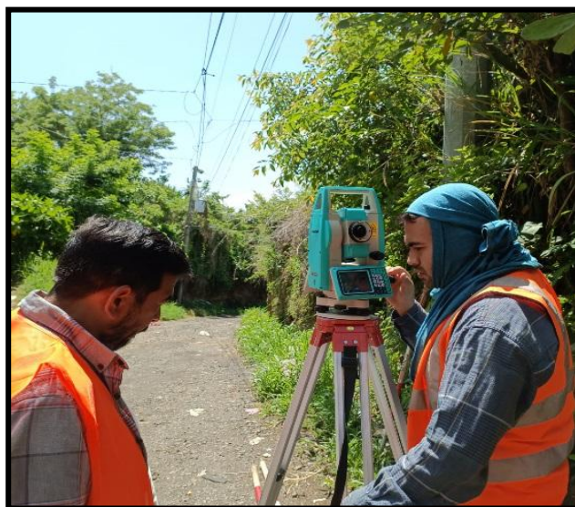
Ilustración 17. Nivelación de estación total y verificación de datos
