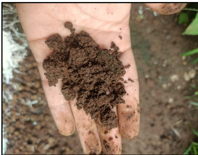
Ilustración 30. Arena Arcillosa de baja plasticidad, color café Claro (SC), ASSHTO A-4.
