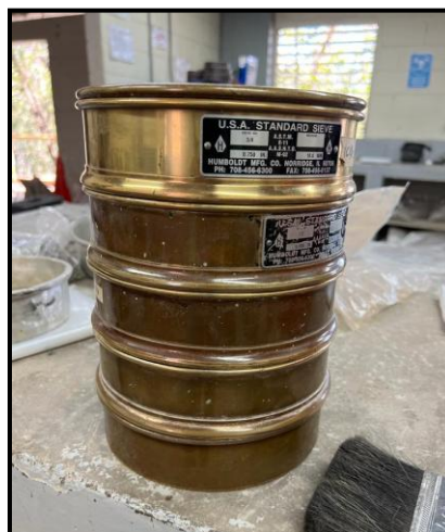
Ilustración 27. Mallas utilizadas para ensayo de granulometría estación 0+350m
