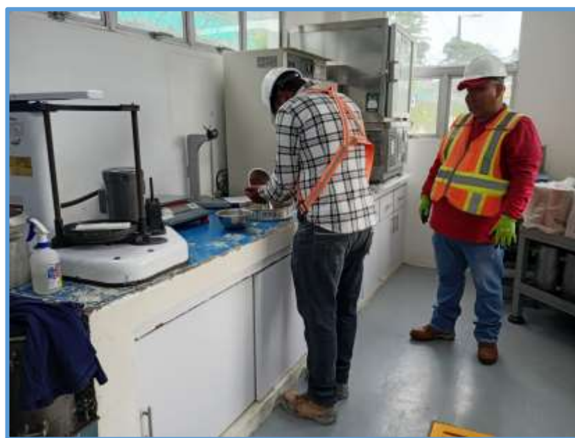
Ilustración 32: Realización de ensayo de Gravedad Especifica y Absorción de Agregados Finos.
