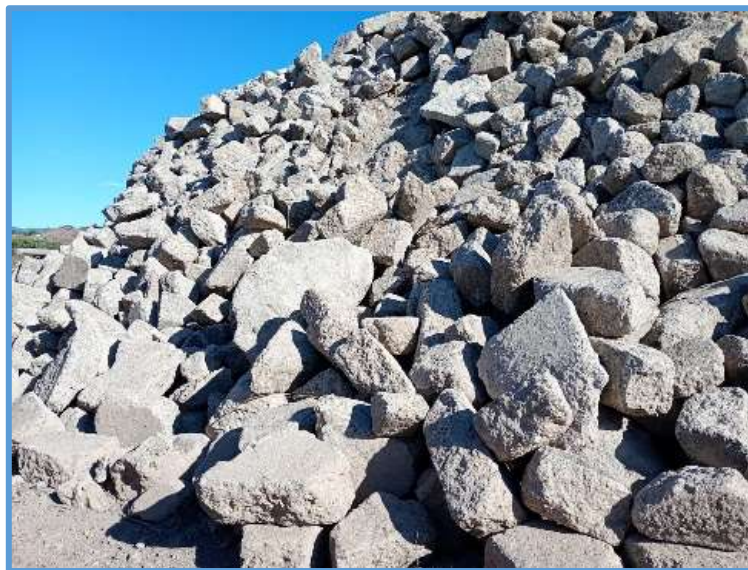
Ilustración 19: Interior de plantel, donde se observa concreto reciclado y/o reciclado.
