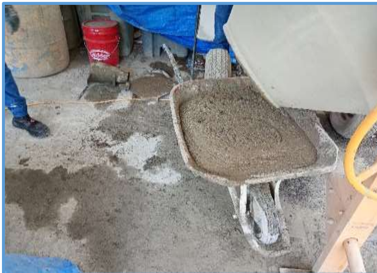
Ilustración 38: Muestreo de Material de Resistencia Baia Controlada RFES.
