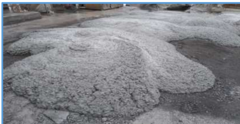
Ilustración 12: Concreto retornado a planta.
