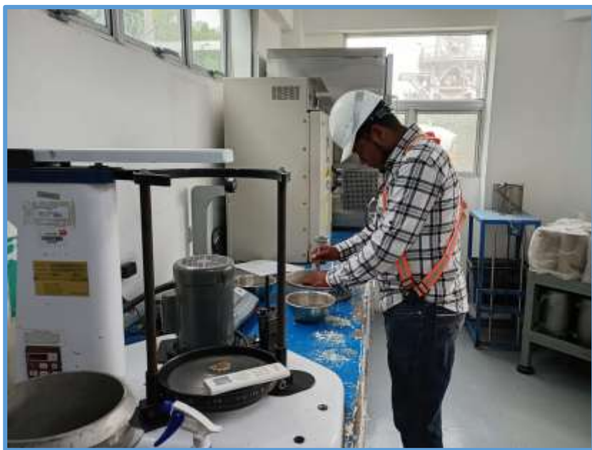
Ilustración 31: Realización de ensayo de Gravedad Especifica y Absorción de Agregados Finos.
