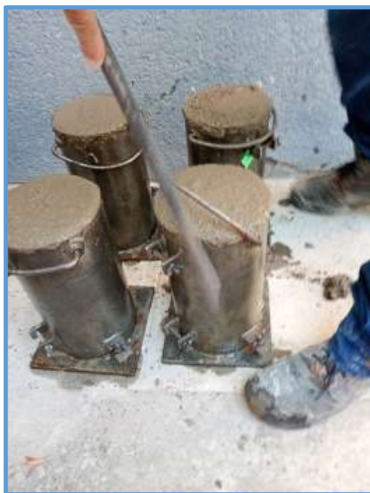
Ilustración 48: Elaboración de especímenes con la mezcla del Relleno Fluido Ecológico Sustentable RFES, para ser ensayado luego.
