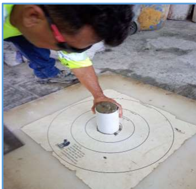
Ilustración 40: Ensayo de Consistencia de Flujo.
