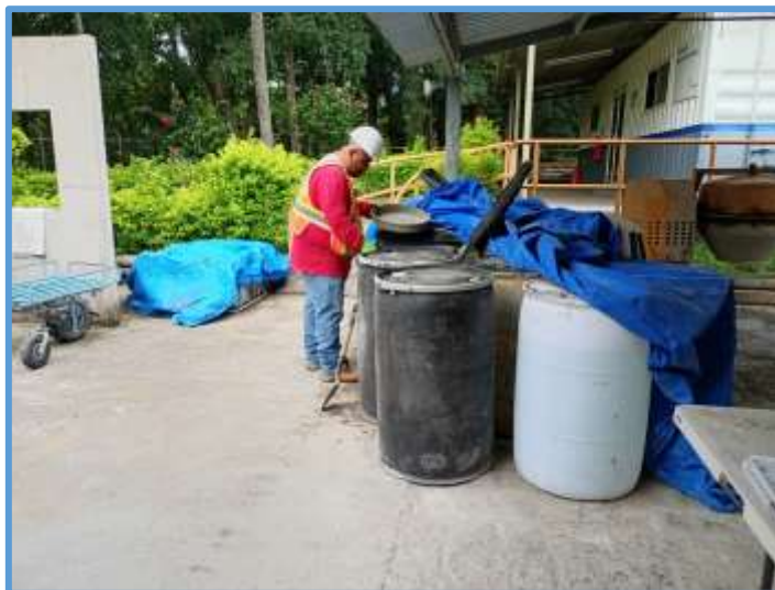
Ilustración 29: Preparación de material fino, pasante de la malla # 200.
