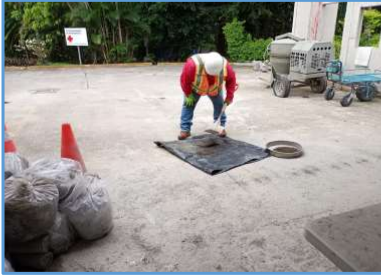
Ilustración 24: Proceso de reducción de muestra para ser ensayada.
