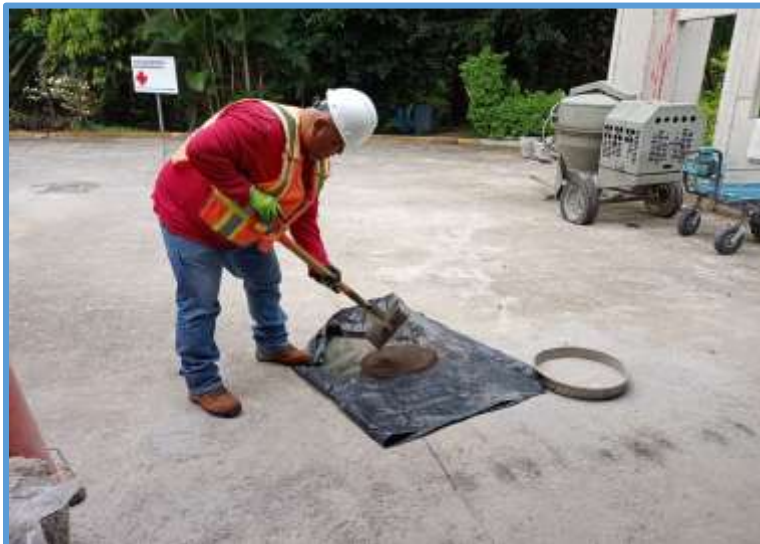
Ilustración 23: Proceso de reducción de muestra para ser ensayada.
