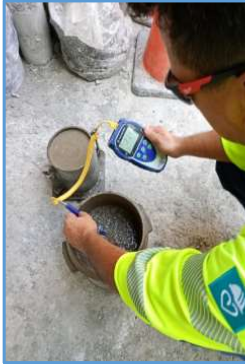
Ilustración 42: Ensayo de Temperatura a muestra fluida.
