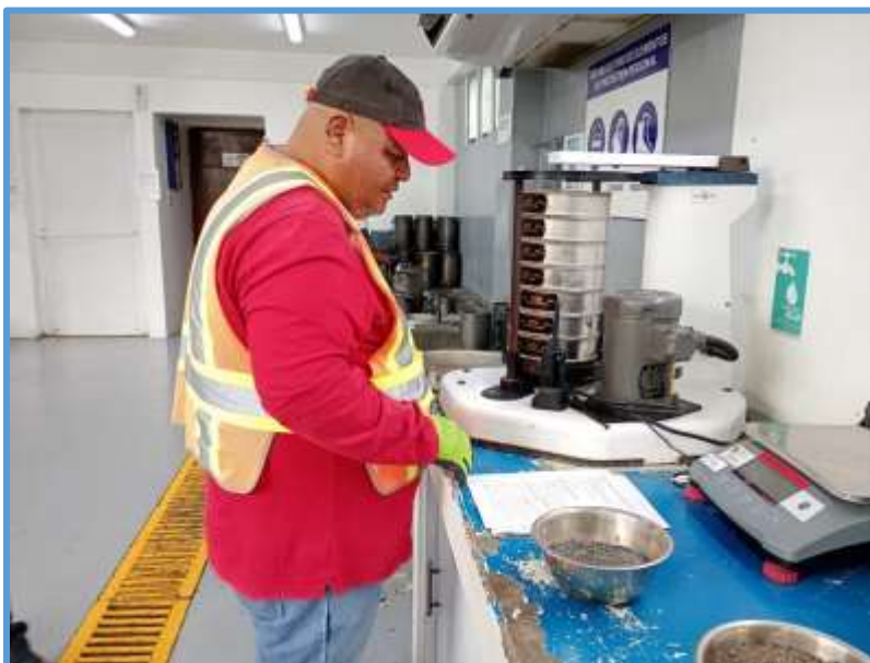
Ilustración 28: Ensayo Granulométrico para agregado fino.
