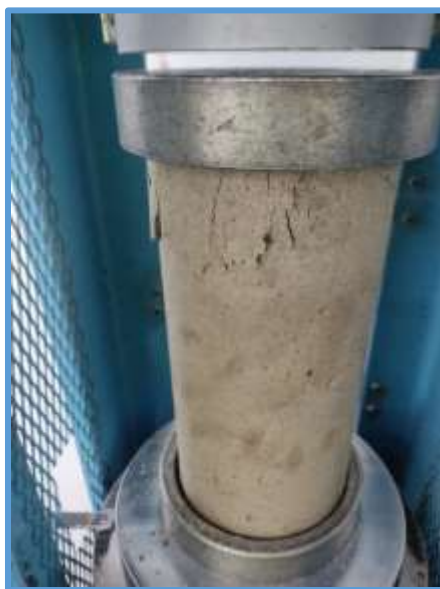
Ilustración 51: Cilindro RFES siendo sometido a compresión.
