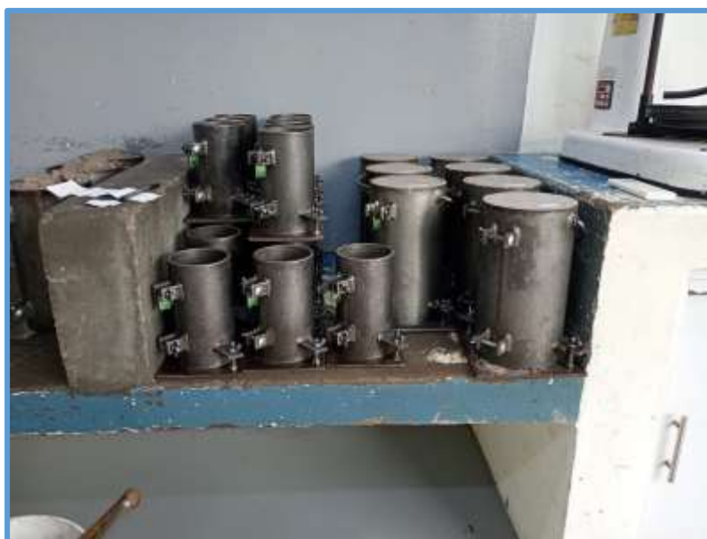
Ilustración 53: Moldes para cilindros según norma ASTM C470.
