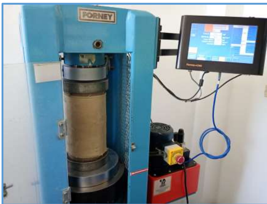
Ilustración 56: Cilindro de mezcla RFES, sometido a compresión.
