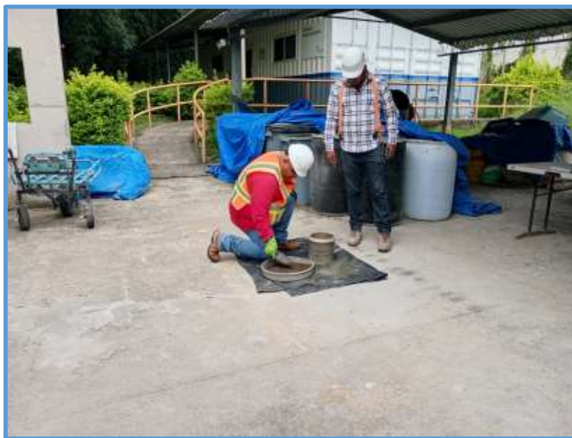
Ilustración 33: Preparación de la muestra para ensayo de Peso Unitario.
