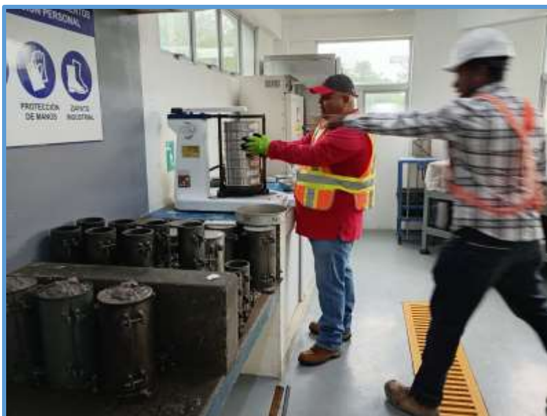
Ilustración 27: Ensayo Granulométrico para agregado fino.
