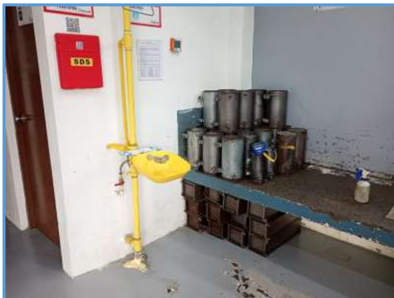
Ilustración 52: Moldes para cilindros según norma ASTM C470.
