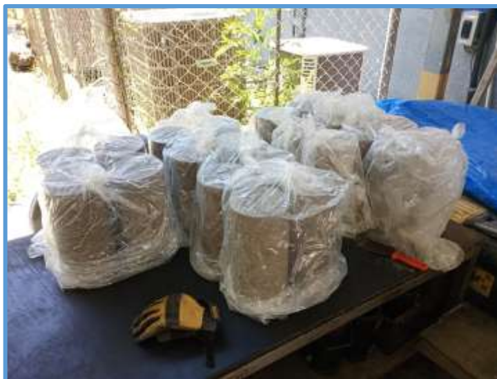
Ilustración 49: Curado de especímenes con la mezcla del Relleno Fluido Ecológico Sustentable RFES, para ser ensayado luego.
