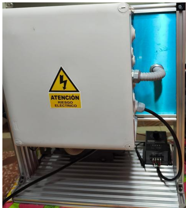
Montaje de caja plexo rectangular a la parte posterior del panel de control.
