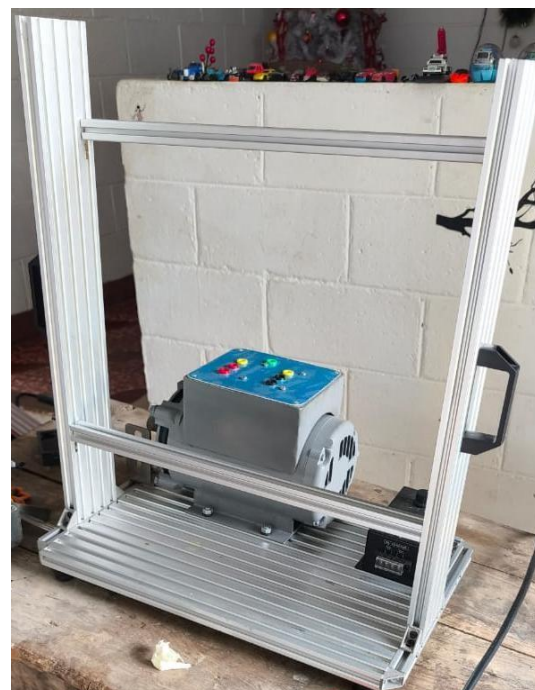
Montaje de motor en estructura del módulo didáctico.
