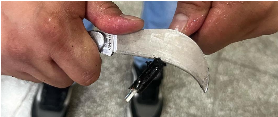
Figura 133. pelado de cable de fibra óptica.
