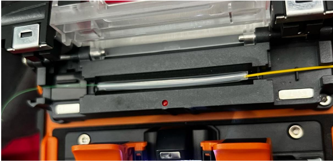
Figura 149. colocación de termo encogible en unión de fibra óptica.
