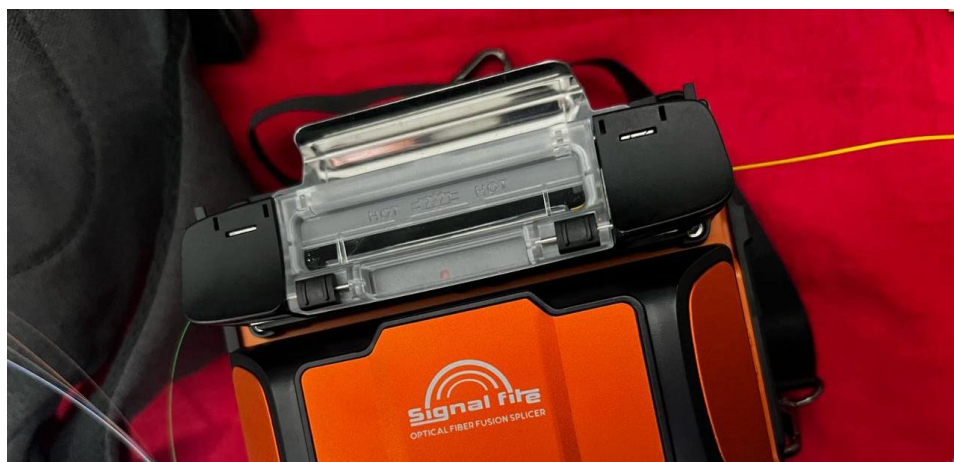
Figura 90 Cables de fibra óptica en horno de fusionadora para termoencogible
