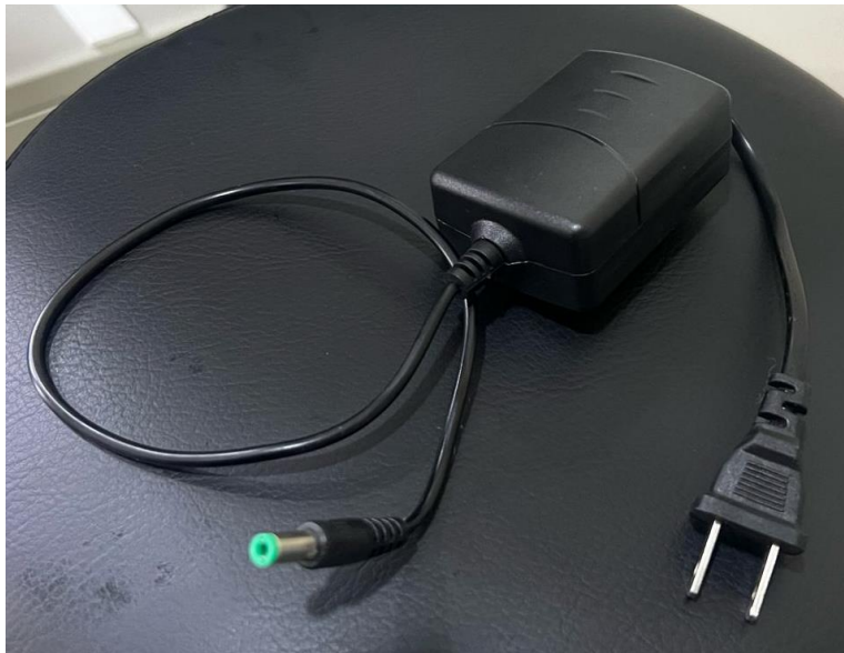
Figura 157. Fuente de alimentación del módulo convertidor de ethernet a fibra óptica.
