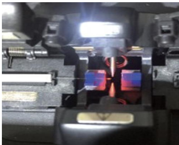
Figura 86. Colocación en la fusionadora Ai-9 de fibra óptica con recubrimiento de caucho
