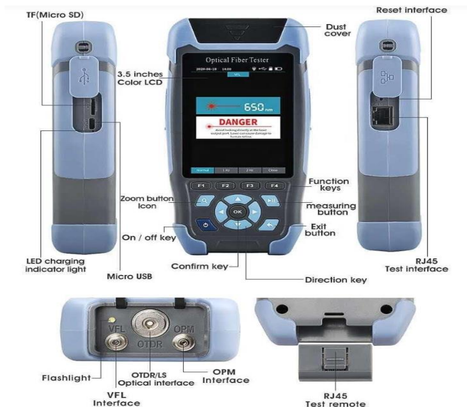
Figura 99. Parte del mini OTDR JW3302. 107
