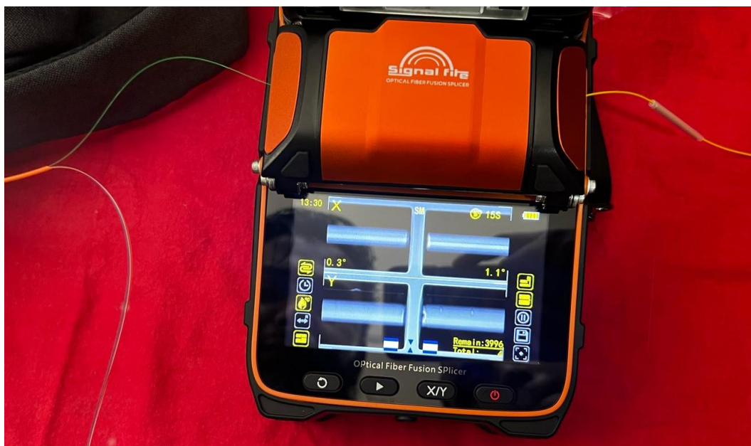
Figura 148. Fusionado de fibra óptica en fusionadora AI9.
