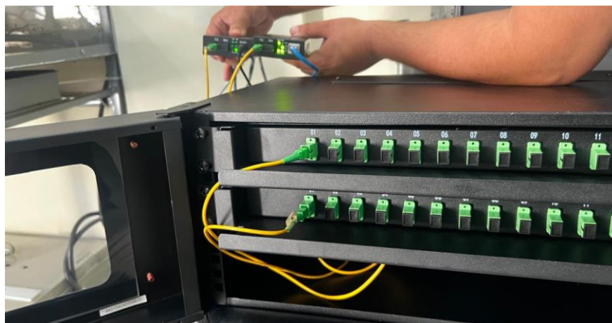
Figura 160. Conexión desde el primer convertidor hasta el segundo convertidor por medio de ODF y fibra óptica.
