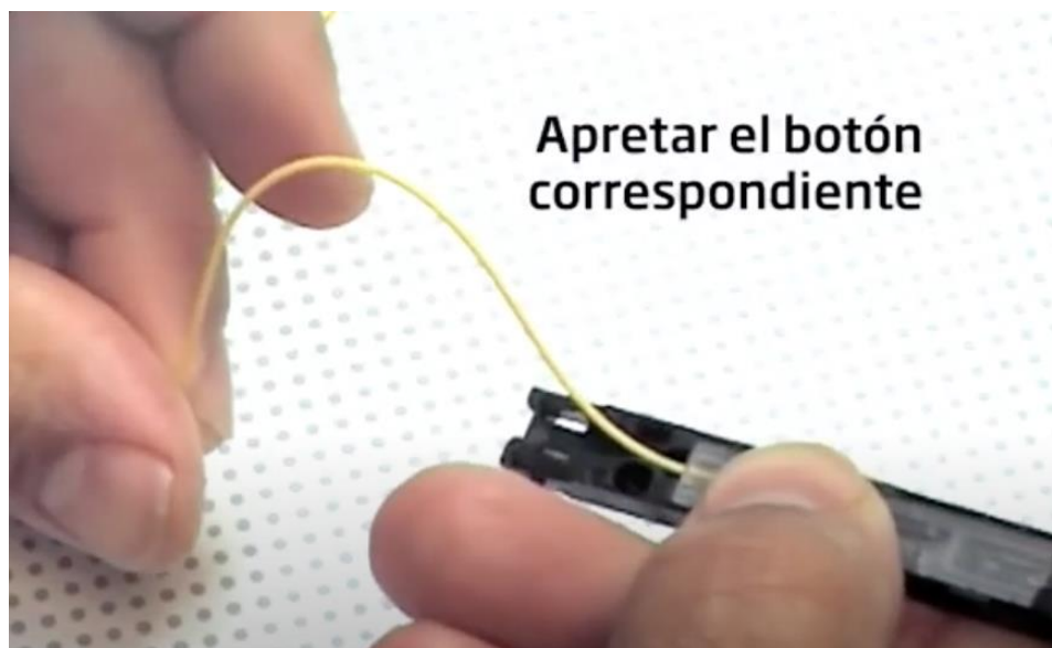
Figura 215. armado de empalme mecánico. 146
