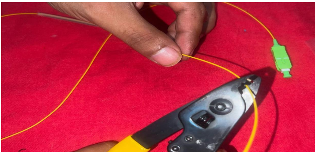
Figura 144. peladora de fibra pelando pigtail SC/APC.
