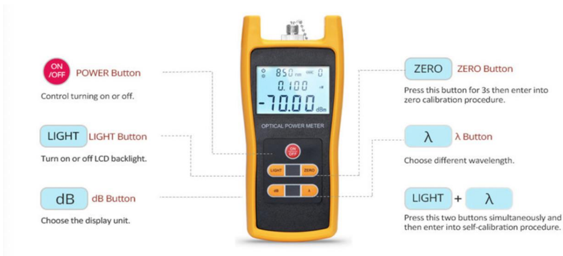
Figura 92. Ubicación y descripción de los botones de un medidor de potencia. 100
