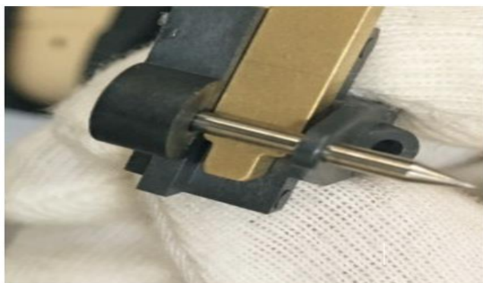
Figura 86. Paso 7 para el reemplazo de electrodos de la Fusionadora SignalFire AI-9. 95
