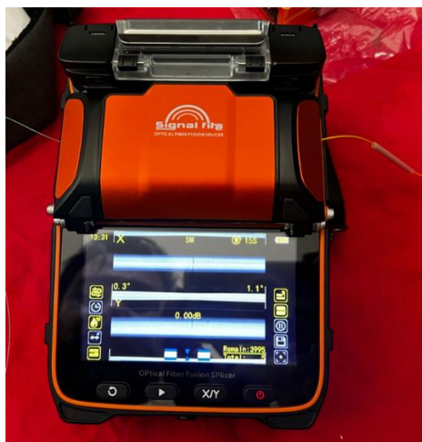
Figura 89. Fusionadora SignalFire AI-9 en proceso de fusión de hilos.
