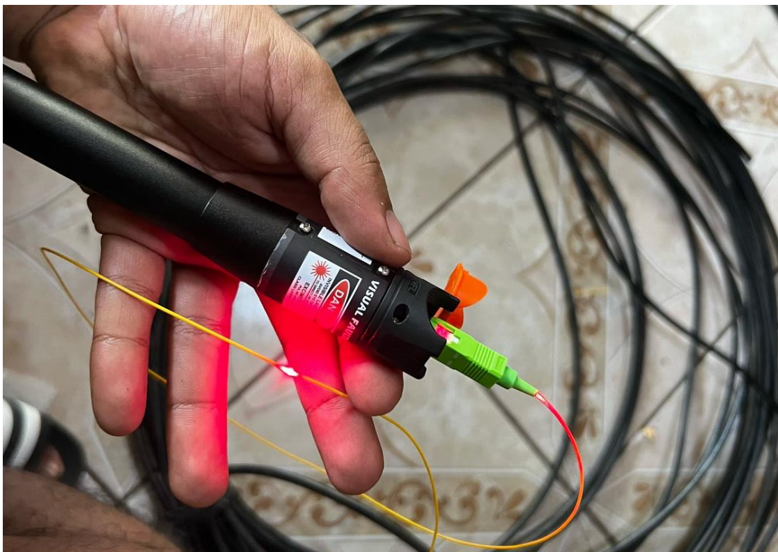
Figura 172. prueba de VFL fibra quebrada.
