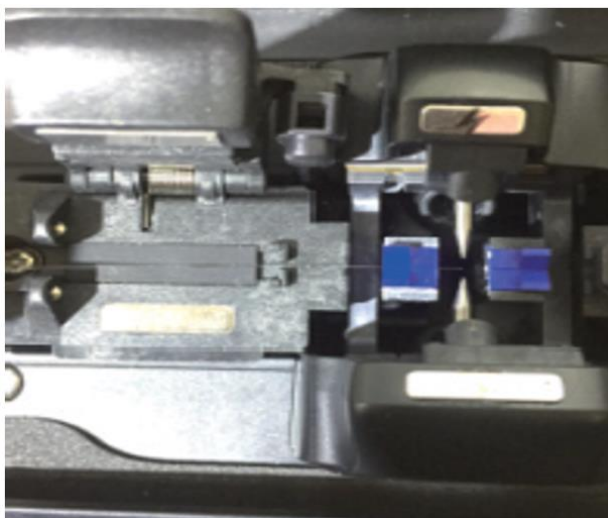
Figura 88. Colocación en la fusionadora Ai-9 de fibra óptica desnuda.
