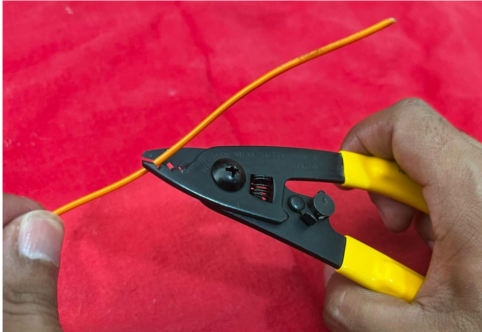
Figura 137. peladora de fibra pelando el tubo holgado.
