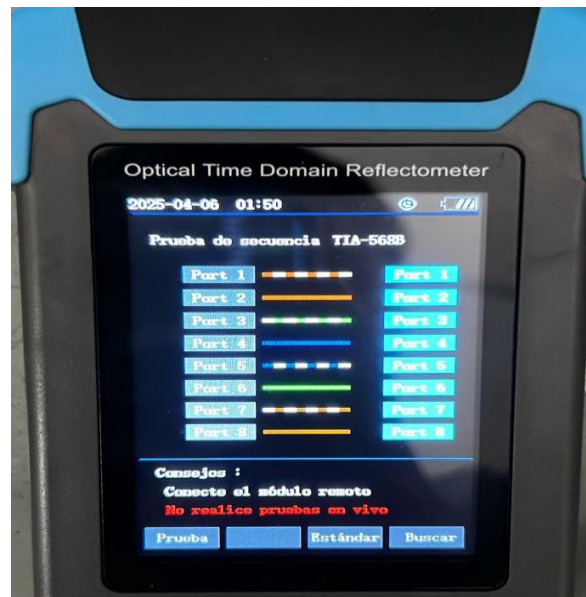
Figura 182. Comprobacion del armado del cable RJ45
