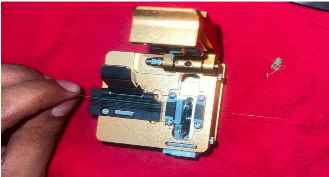
Figura 199. cortes de fibra óptica
