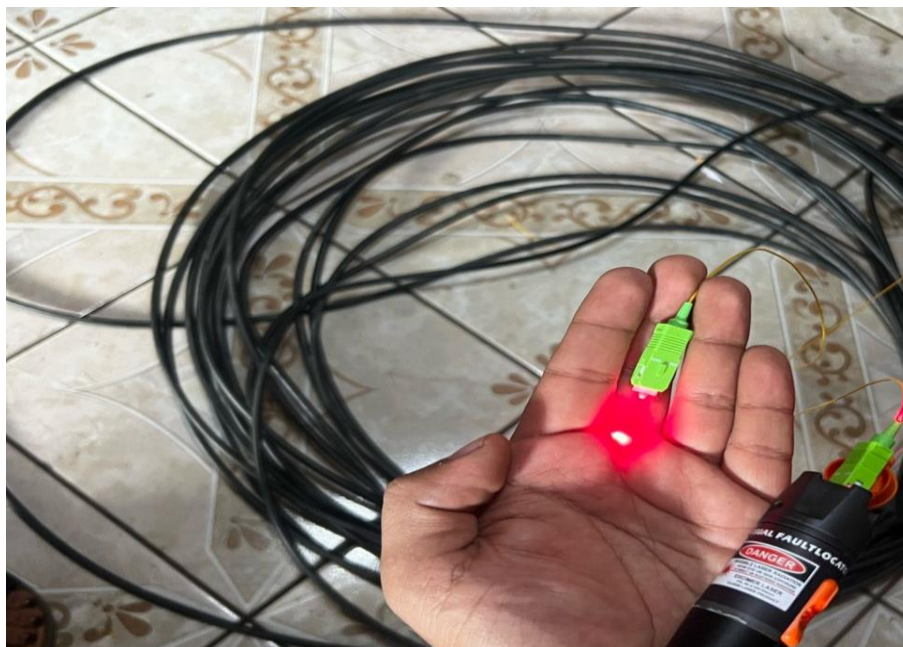
Figura 167. prueba de VFL con haz de luz sin atenuaciones.
