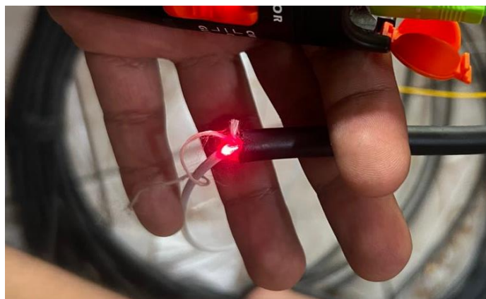
Figura 188. Pérdida de luz en fibra por macrocurvatura.
