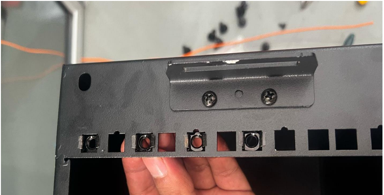
Figura 150. colocación de muelas en gabinete.
