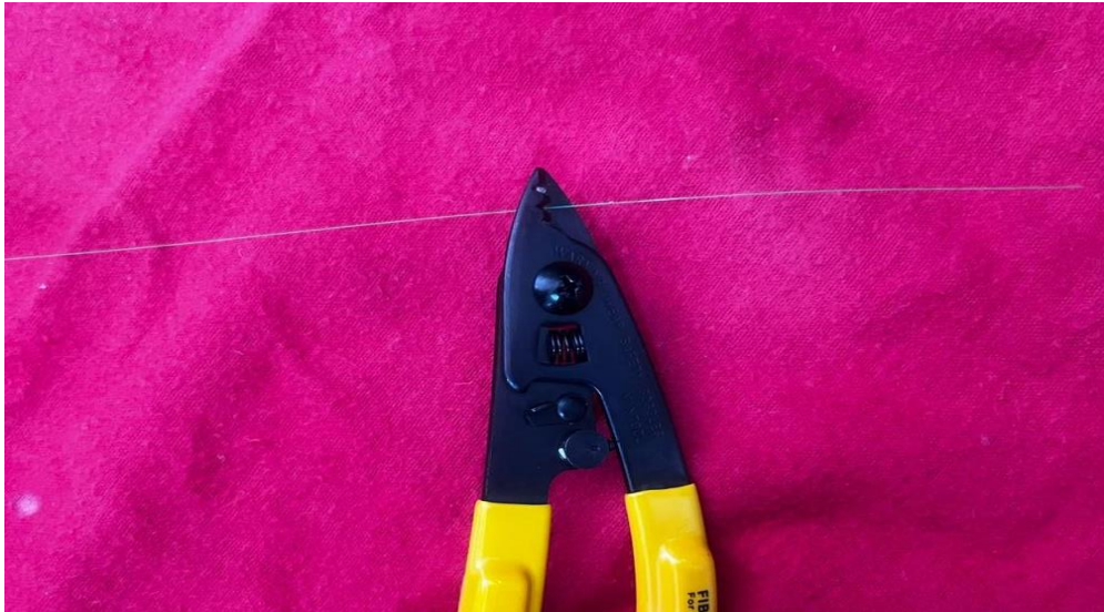
Figura 198. pelado de fibra óptica.
