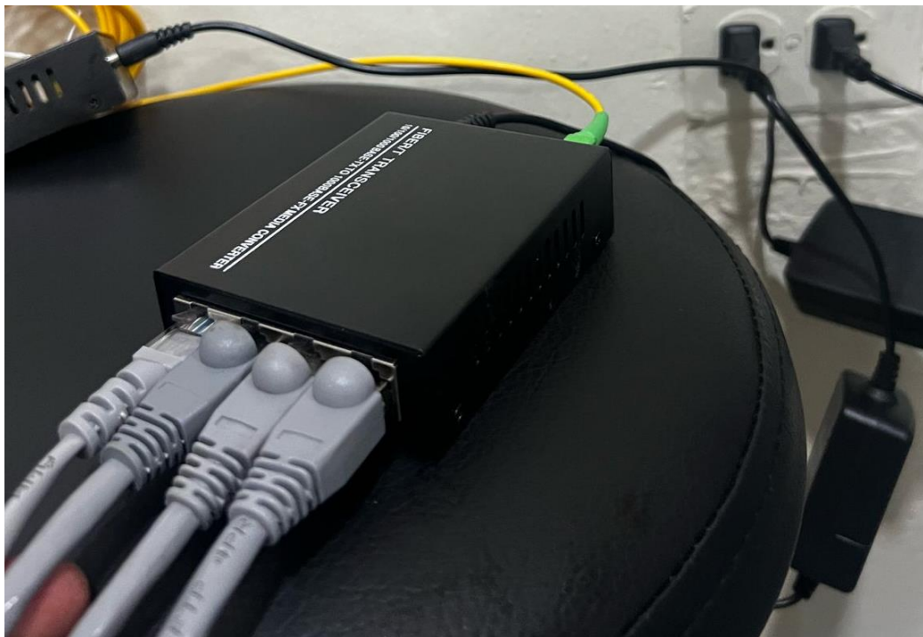
Figura 161. Convertidor de fibra óptica a ethernet con cuatro salidas RJ45.
