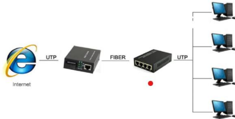
Figura 114. Diagrama de conexión de una red con convertidores de fibra óptica a ethernet. 121
