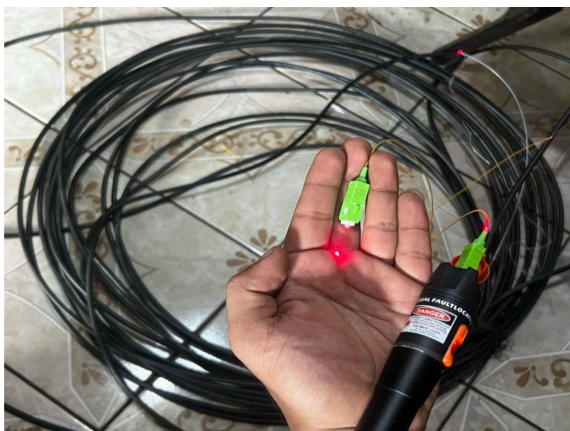
Figura 168. prueba con VFL haz de luz tenue, y con visible luz en el tramo del cable.
