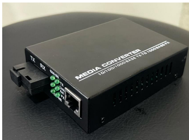
Figura 156. Convertidor de medios ethernet a fibra óptica.
