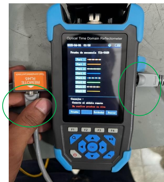
Figura 180. Conexión de cables RJ45 en mini OTDR
