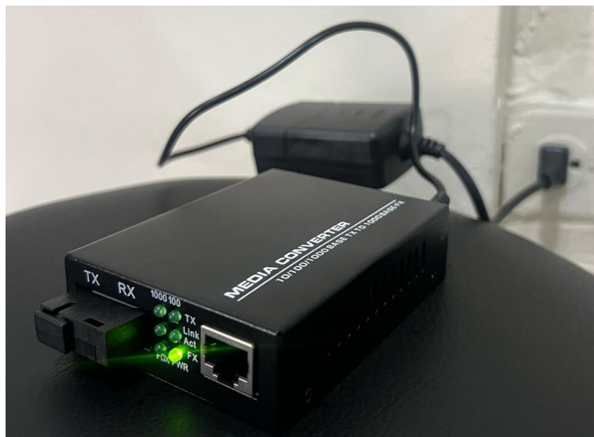
Figura 158. Modulo convertidor de ethernet a fibra óptica energizado.
