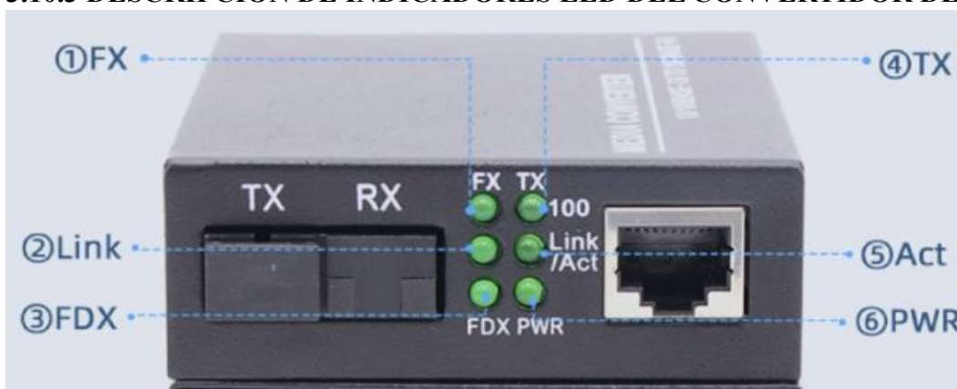
Figura 113. Parte frontal del convertidor de fibra óptica a ethernet.
