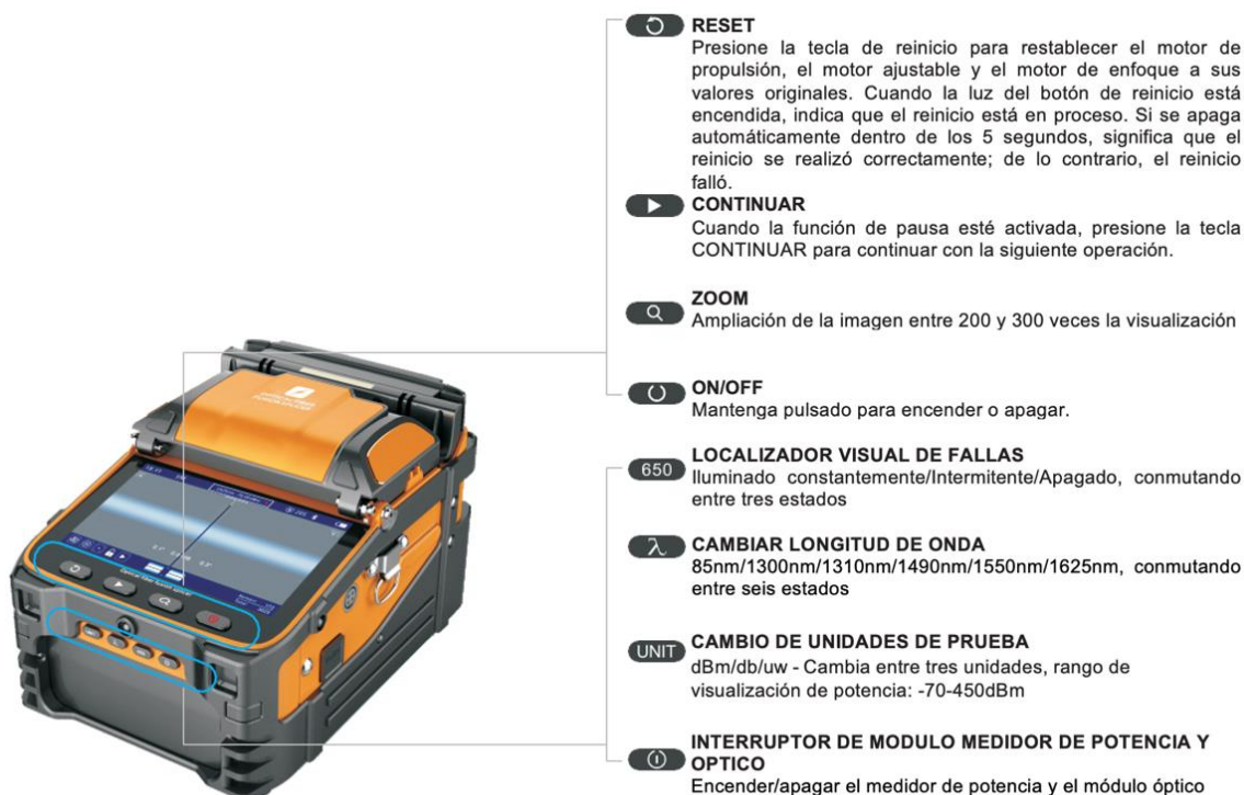
Figura 71. Teclas de operación de la fusionadora SignalFire AI-9. 77
