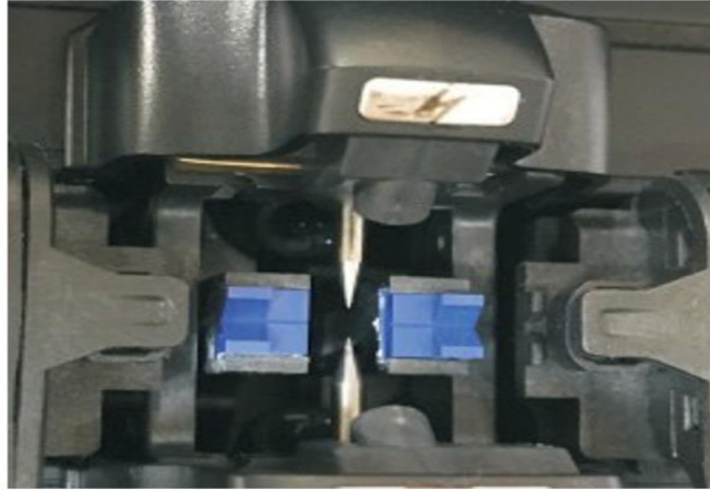
Figura 90. Paso 11 para el reemplazo de electrodos de la Fusionadora SignalFire AI-9. 99
