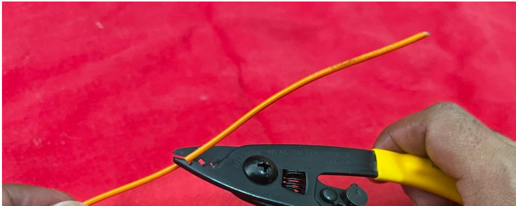
Figura 196. pelado de buffer.
