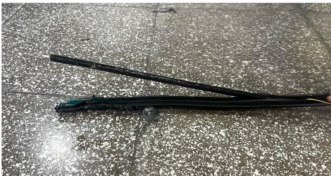
Figura 132. extracción del cable interno de la cubierta de PVC.
