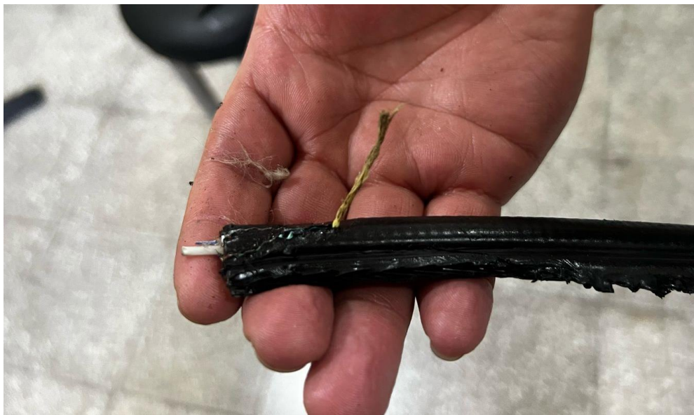
Figura 131. Ubicación de hilo para pelado de cable.
