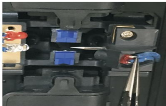
Figura 88. Paso 9 para el reemplazo de electrodos de la Fusionadora SignalFire AI-9. 97
