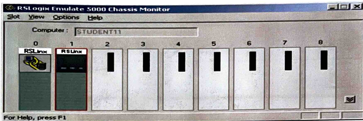
Imagen 5: Permite la depuración de programas y la verificación de la lógica de control sin necesidad de hardware real.
