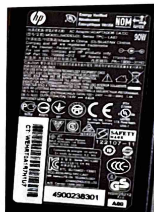
Anexo 2: Especificaciones técnicas del Adaptador CA, con 1.6 A de 90 W
