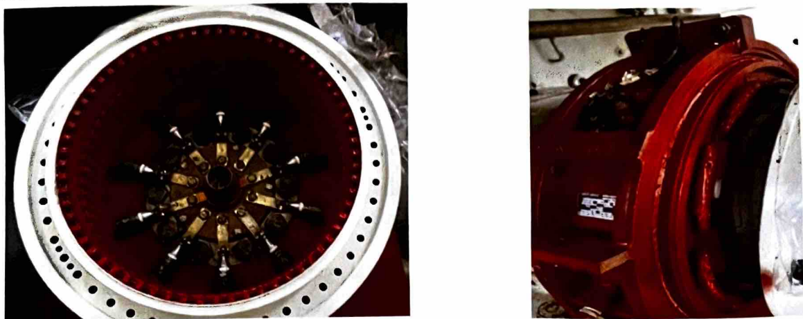
Imagen 90: Rectificador de diodos giratorios y Generador de imanes permanentes.
