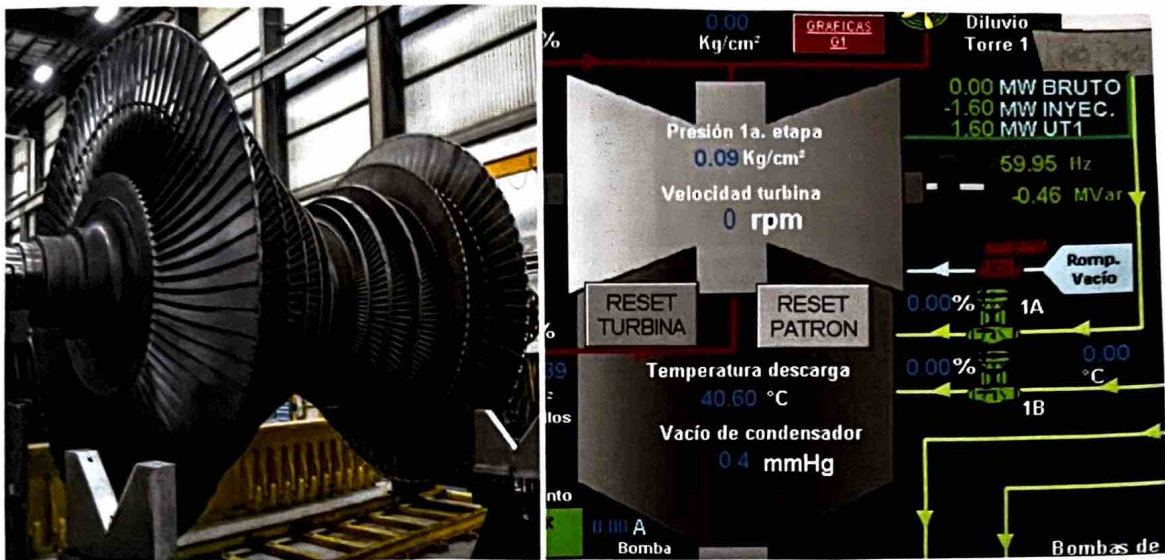
Imagen 78: Rotor de turbina y condensador con sus valores representado en la simulación.
