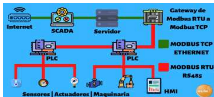
Ilustración 36 Arquitectura básica de Modbus
