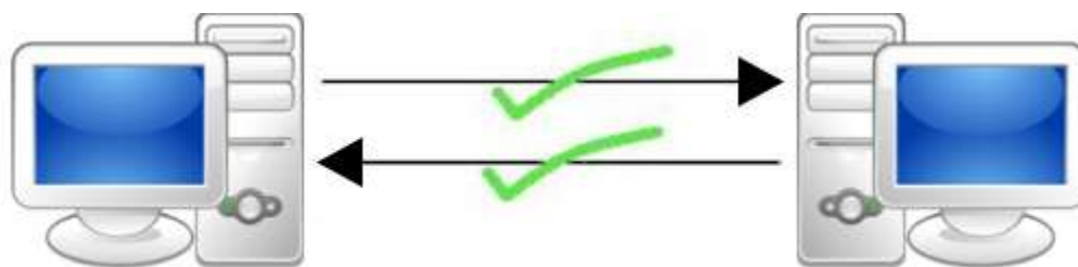
Ilustración 57 Conexión dúplex completo
