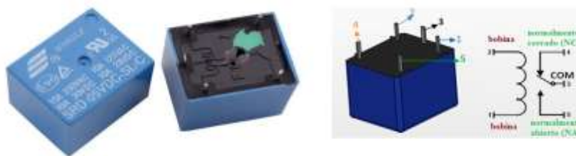
Ilustración 6 Presentación del relé y configuración de pines
