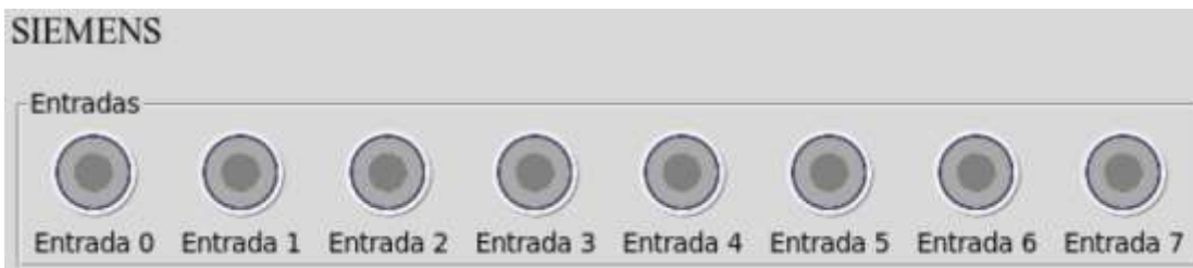
Ilustración 90 Indicadores luminosos desactivado en interface grafica
