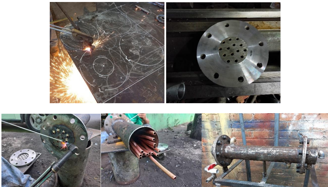
Figura 4.3 Fabricación intercambiador carcasa y tubos 1-2 (Fuente: Elaboración propia)
