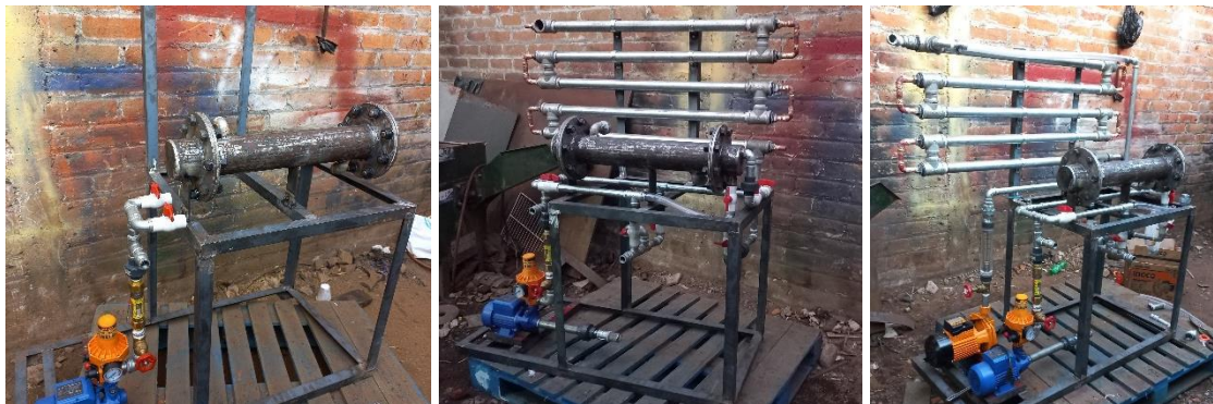
Figura 4.4 Fabricación y conexión de tuberías hidráulicas (Fuente: Elaboración propia)
