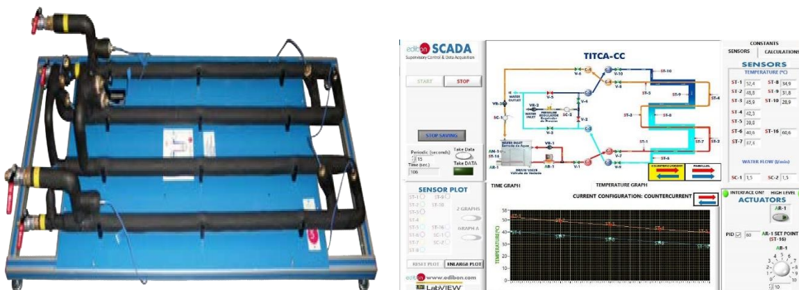
Figura 2-1 Intercambiador de Calor de Tubos Concéntricos Ampliado para TICC. Pantalla principal del Intercambiador de Calor de Tubos Concéntricos Ampliado (TITCA). Opción de operación: Contracorriente (CC), (Edibon International, 2021). 42
