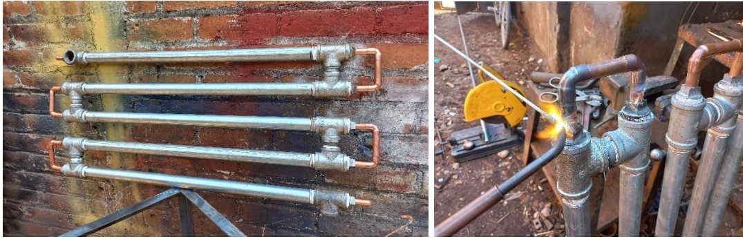
Figura 4.2 Fabricación intercambiador tubos concéntricos (Fuente: Elaboración propia)
