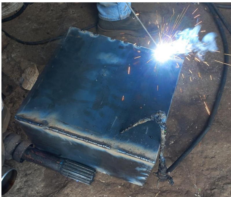
Figura 4.5 Fabricación tanques almacenamiento (Fuente: Elaboración propia)
