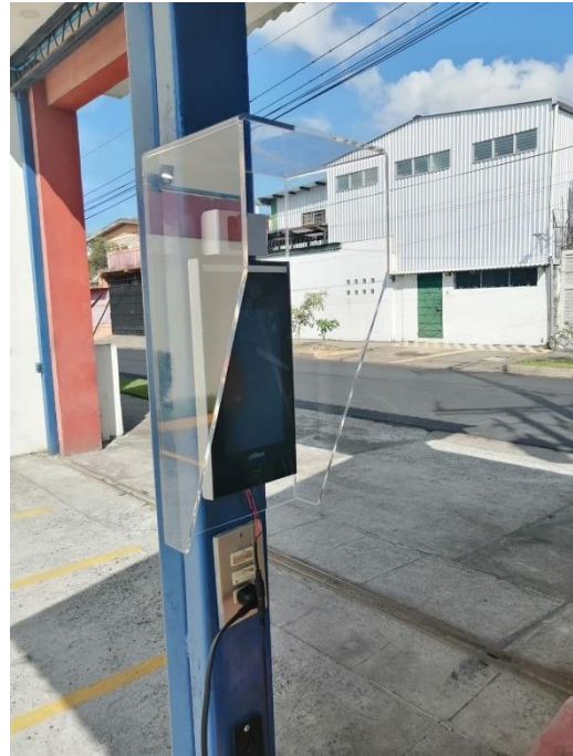
Figura 91 Imagen Izquierda Instalación y conexión de control de acceso, imagen derecha ubicación sugerida para la toma de temperatura.
