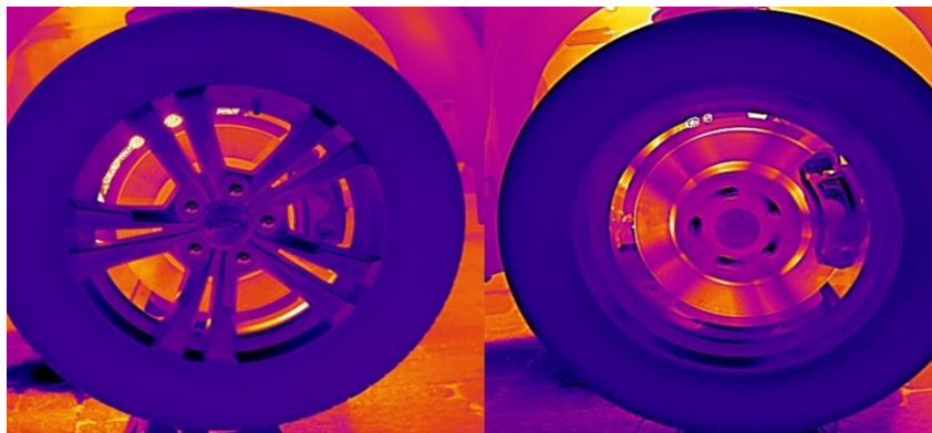
Figura 25: Imágenes térmicas del movimiento en alta velocidad un neumático (Izq.) tomada por una cámara refrigerada y la capturada por una cámara no refrigerada (Der.)
