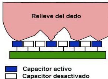
Figura 6: Principio funcionamiento del lector capacitivo de huella digital
