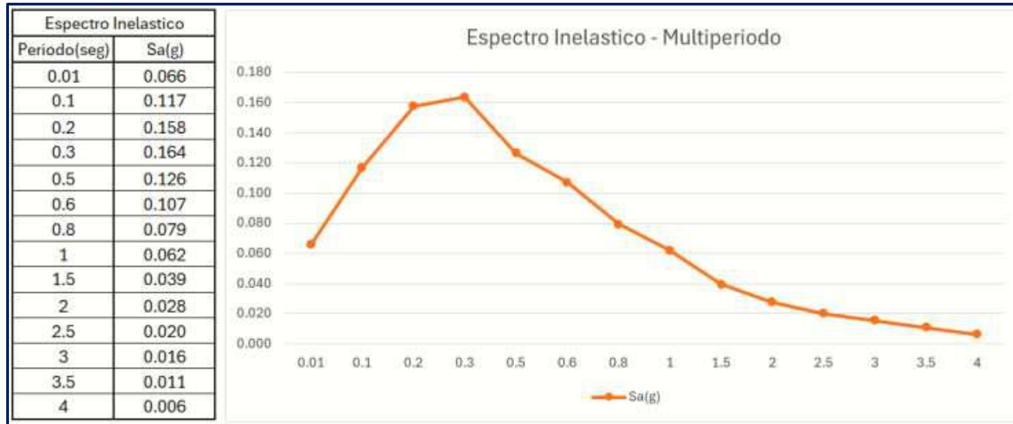
Espectro Inelástico - Multiperiodo.
