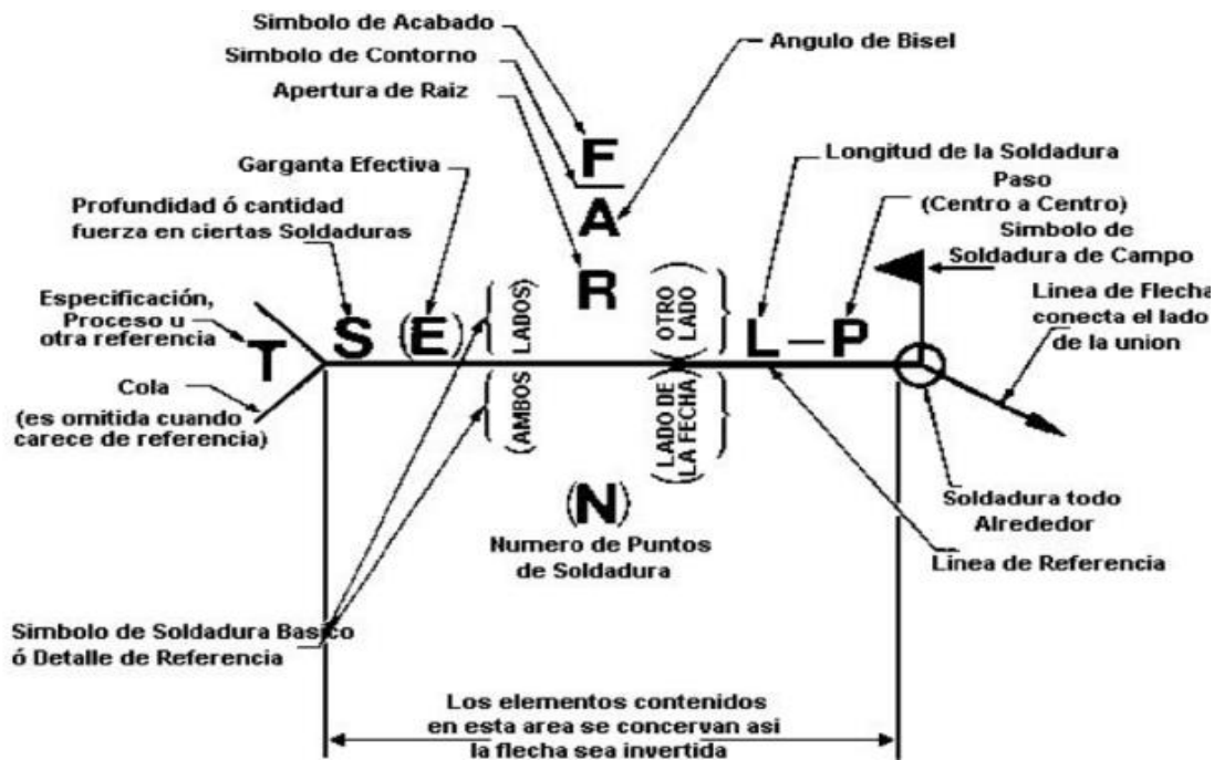
Ilustración 6. Símbolo completo de soldadura.
